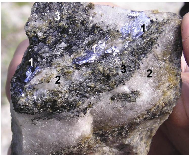
Рис. 43. Кристаллы молибденита (1) в мелкозернистом кварце (2) и карбонатите (3). Карьер по отработке кварцевой жилы № 175
