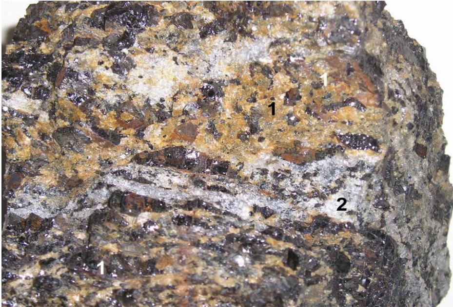
Рис. 129. Массивную карбонат-магнетитовую руду (1) сечет кварц-магнетитовый агрегат (2). Теплогорское месторождение магнетита
