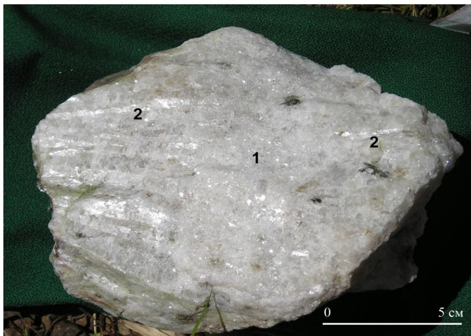
Рис. 33. Мелкозернистый «сахаровидный» альбитит (1) сечет гигантозернистый анортоклаз, имеющий «лунный» отлив на плоскостях спайности (2). Слюдяногорское месторождение мусковита, штольня № 4
