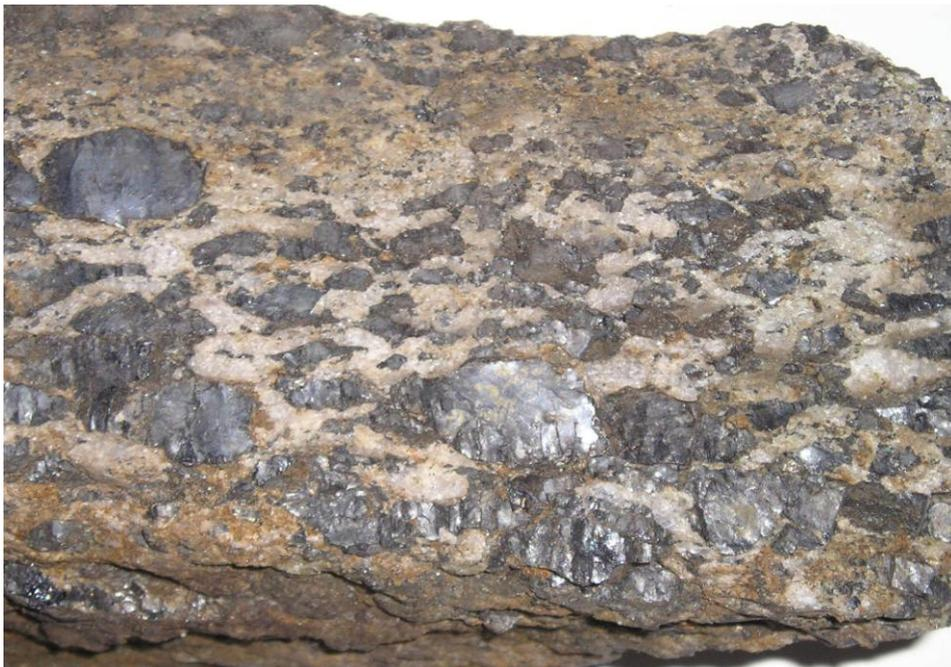
Рис. 128. Массивная кальцит-магнетитовая руда (уменьшено в два раза). Теплогорское месторождение магнетита
