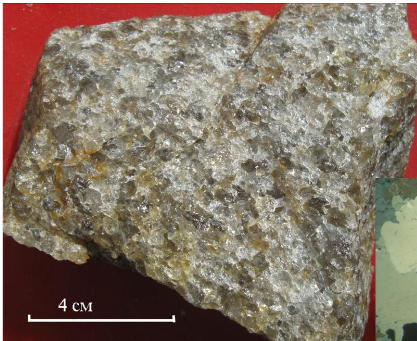
Рис. 64. Гранобластовый кварц жил перекристаллизации. Кыштымское месторождение, жила 170, образец У-358. На врезке шлиф У-358, с анализатором, увел. 20X
