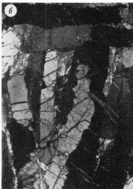
Фото 3. Удлиненно-призматические лейстовидные кристаллы оливина в неравномерно-зернистом дуните. а - Тарлашкинский массив, шл. 328/3, с анализатором, ув. 40; б - гипербазитовый массив горы Зеленой (Кузнецкий Алатау), шл. 629а, с анализатором, ув. 60.
