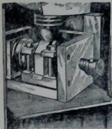
Рис. 47. Общий вид прибора для испытания на двойной срез со сжатием
