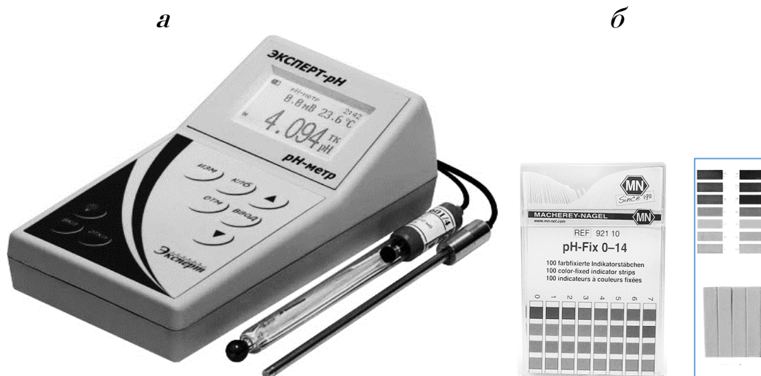
Рис. II-1 – pH-метр со стеклянным электродом, термометром и функцией автоматической термокомпенсации (а), индикаторные полоски различных производителей (б).
