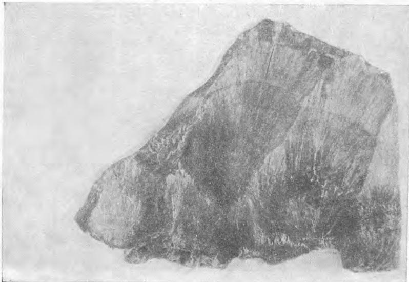
Рис. 10. Радиально-лучистая метаколлоидная структура малахита со следами первичного концентрически-зонального строения. Деталь строения штуфа рис. 9. Ув. 4
