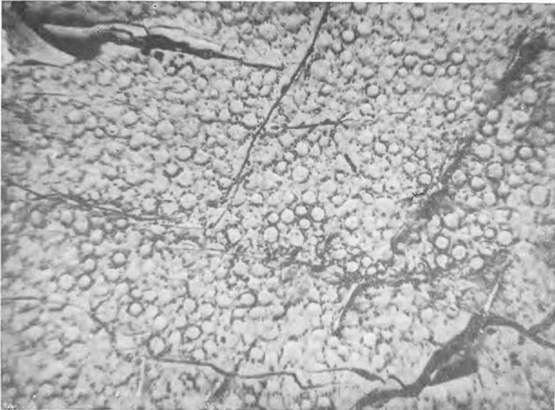
Рис. 66. Ложный рисунок структуры пирротина, протравленного в парах царской водки. Такие же фигуры появляются на поверхности зерен сфалерита, перетравленного в парах царской водки. Полированный шлиф. Ув. 100
