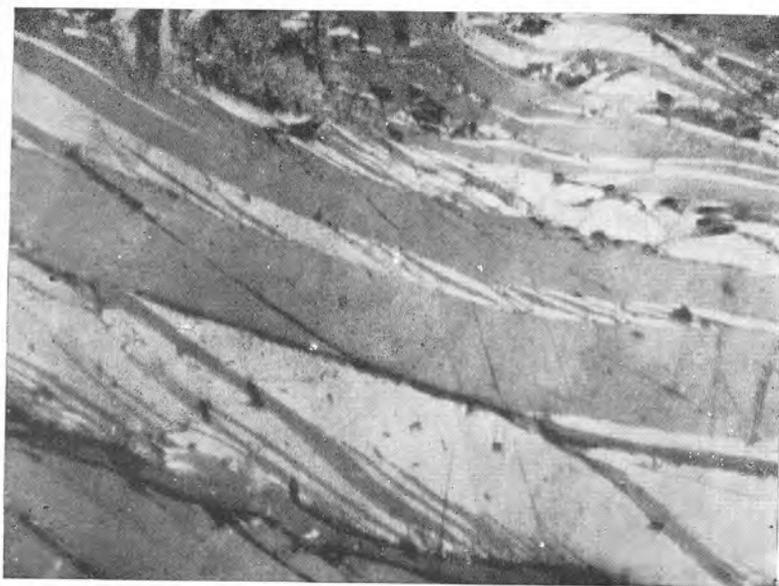
Рис. 77. Фигуры смятия развиваются по диагонали в пластинках молибденита. Месторождение Каджаран. Полированный шлиф. Николи скрещены. Ув. 40
