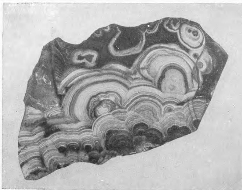
Рис. 37. Колломорфная и почковидная текстуры коллоидных агрегатов малахита. Структура агрегата концентрически-зональная. Место-рождение Высокогорское, Урал. Поллированный штуф. Нат. вел.
