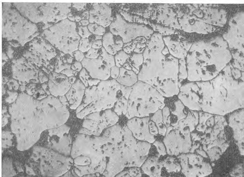
Рис. 15. Гранобластическая структура пиритового агрегата в обломках. Протравлен  $\text{HNO}_3 + \text{CaF}_2$  в течение 3 минут. Тот же штуф, что и на рис. 13. Ув. 80
