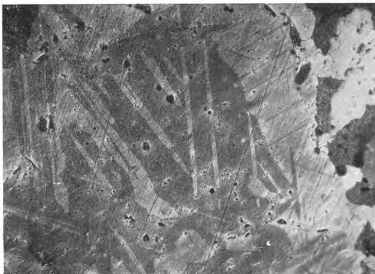
Рис. 75. Полисинтетические двойники превращения в халькопирите (протравлен). Двойники веретенообразной формы возникают перед перекристаллизацией агрегата. Месторождение Айгедзор, Армянская ССР. Полированный шлиф. Ув. 85
