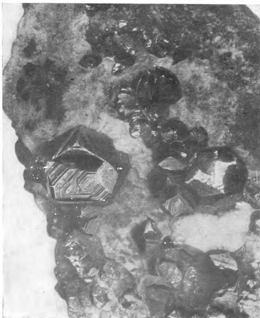
Рис. 31. Друзовая текстура выполнения пустот. Крупные кристаллы пирита в форме пентагондодоэдра и октаэдра (с зональным строением) нарастают на трещине в породе. Месторождение Парагачай. Наг. вел.
