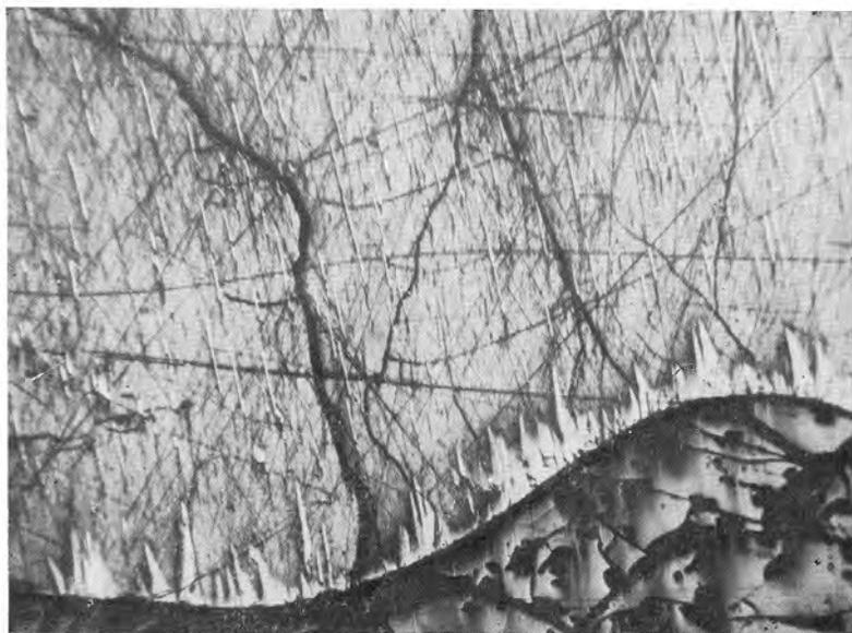
Рис. 116. Пластинчатая и пламенивидная структуры распада твердого раствора пирротин (серый) + пентландит (белый). Пирротин протравлен КОН. Внизу зерно магнетита. Видны трещины. Месторождение Монча-Тундра. Полированный шлиф. Ув. 85
