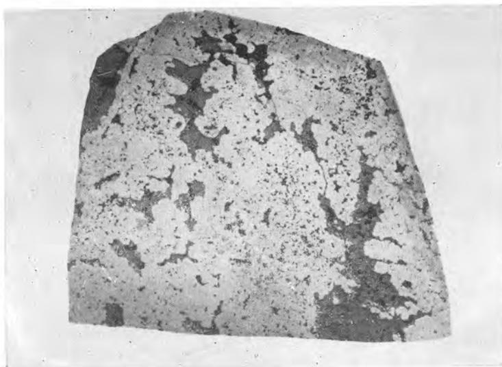
Рис. 60. Графическая текстура замещения. Агрегат пирита (белый с черными выбоинами) замещается агрегатом энэргита (серый). Месторождение Кафан. Полированный штуф. Нат. вел.
