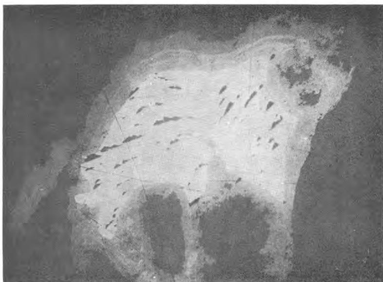
Рис. 55. Зональная каемочная микротекстура. По периферии агрегата галенита (белый) развивается зональная каемка из англезита (светло-серый, ближе к галениту) и церуссита (серый, ближе к породе). Темная основная масса — известняк. По М. И. Калганову. Малкинское месторождение. Полированный шлиф. Ув. 40
