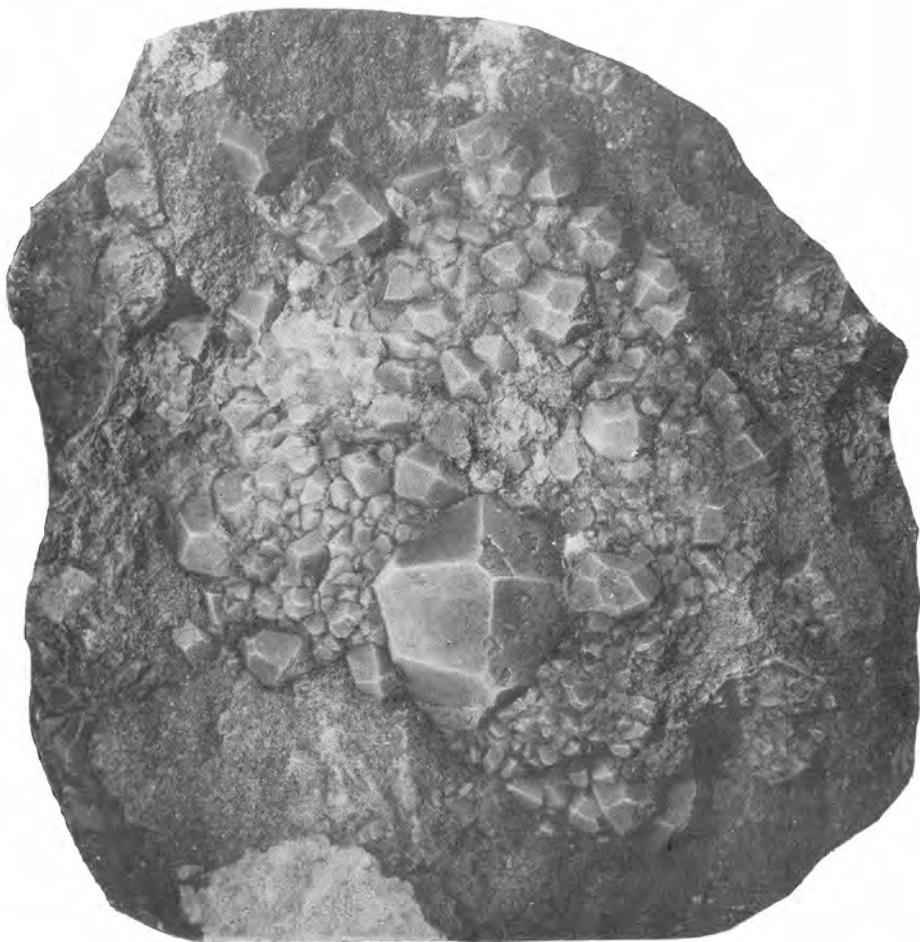
Рис. 32. Друзовая текстура перекристаллизации. Друза граната образовалась метасоматически в магнетито-гранатовом скарне. Высокогорское месторождение, Урал.
