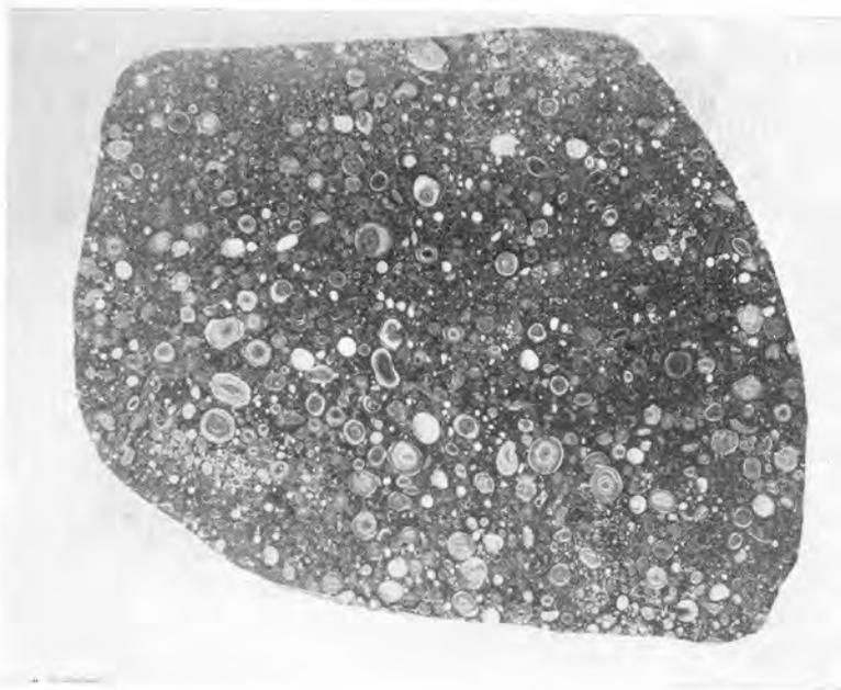
Рис. 35. Оолитовая текстура железной руды. Видно концентрически-зональное строение отдельных оолитов. По М. И. Калганову. Керченское месторождение. Полированный штуф. Нат. вел.
