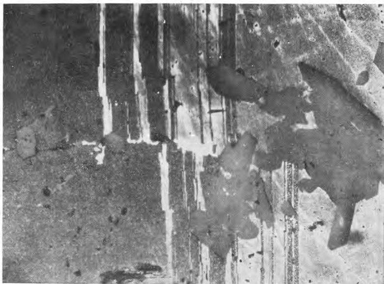
Рис. 94. Идиоморфнометазернистая структура. Метакристаллы кварца (темно-серый) в сфалерите (протравлен, полоски черного и серого цвета) приурочены к трещинкам дробления и пересекают двойники роста. Полированный шлиф Ув. 70
