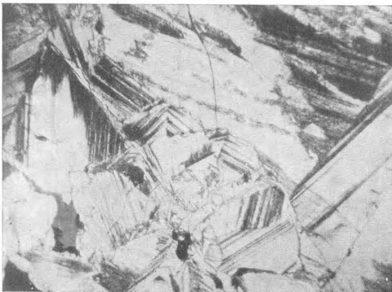
Рис. 70. Тонкие штрихи зональности внутри метакристаллов кобальтина (протравлен). Зональность 2-го рода. Месторождение Дашкесанское. Полированный шлиф. Ув. 160
