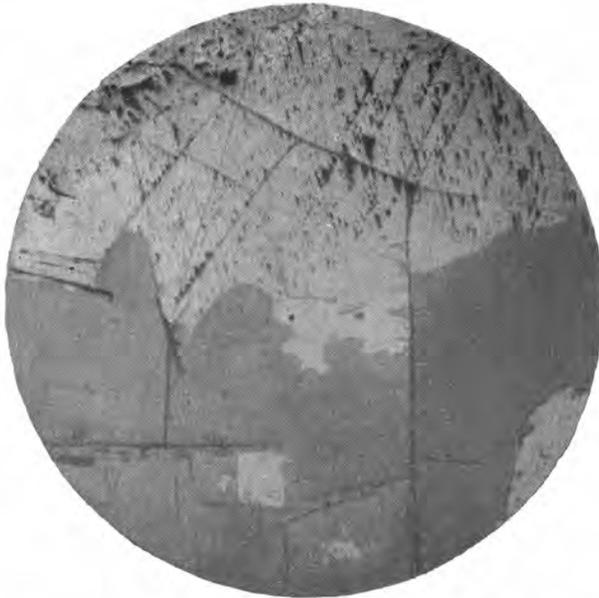
Рис. 62. Микротекстуры разъедания и реликтовая, образующиеся при замещении агрегата галенита (белый) агрегатом гипергенных минералов — ковеллитом и англезитом (серый). Полированный шлиф. Ув. 40
