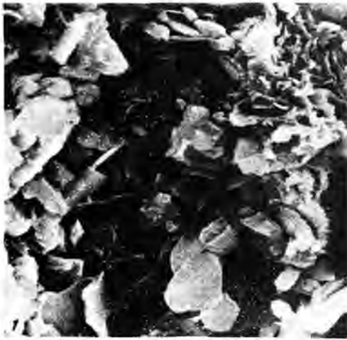
Рис. 61. Электронно-микроскопические фотографии обр. 2639 (222–230 см) – 3000* с пластинчато-листовым строением поверхности (1) и обр. 2639 (350–355 см) – 3000* с плоскоугловатыми обломками минералов и зернами пирита (2)
