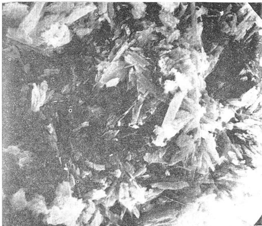
Рис.2. Щепковидная ультрамикроструктура гипергенных фосфоритов месторождения Сарминского. Обр. К-320-2. Увеличение 4000. Сканирующий электронный микроскоп.
