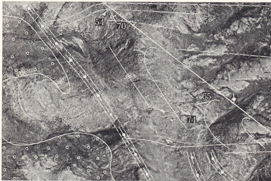
Рис. 2. Пример дешифрирования пород гранулитового комплекса опрокинутой антиклинальной складки
