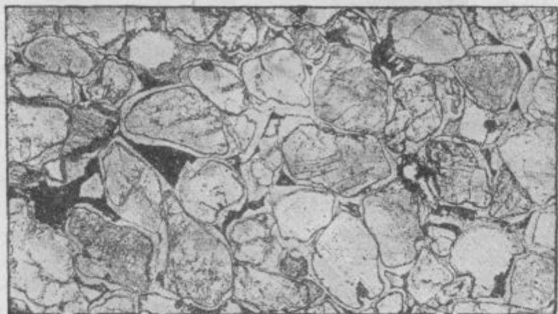
Фиг. 1. Кварцит с цементом регенерации (разрастания). Отчетливо видны первоначальные контуры зерен. (По Л. Кайэ, 1916).
