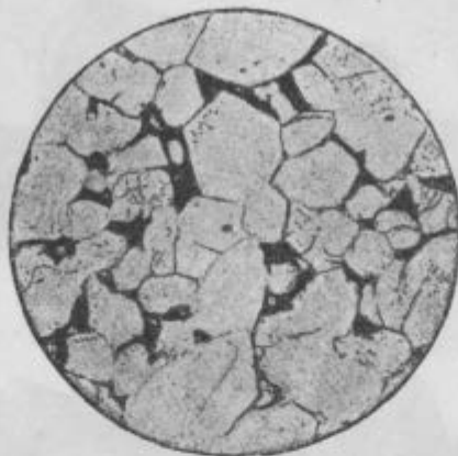
Фиг. 1. Кварцит с регенерированными зернами кварца.
