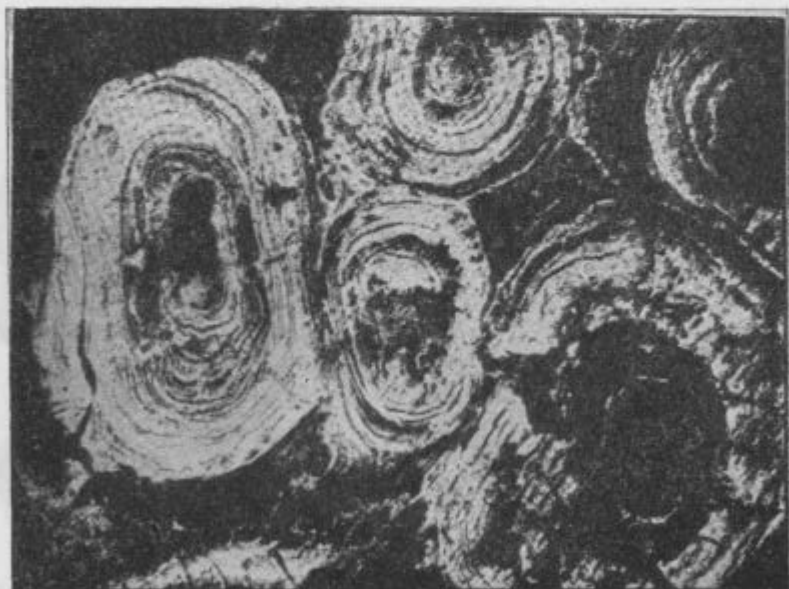
Фиг. 2. Группа «оолитовых» рудных зерен, состоящих из псиломелана и пиролюзита. В цементе между зёрнами сажистый пиролюзит. Нагорье Перевиси. Полированный шлиф. Увел. 18. (По А. Г. Ветехтину, 1937).
