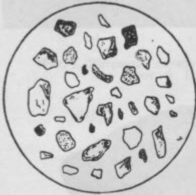
Фиг. 2. Китайский лёсс под микроскопом. Увел. ок. 25. (По Мэригду, из Г.Мильнера, 1929).
