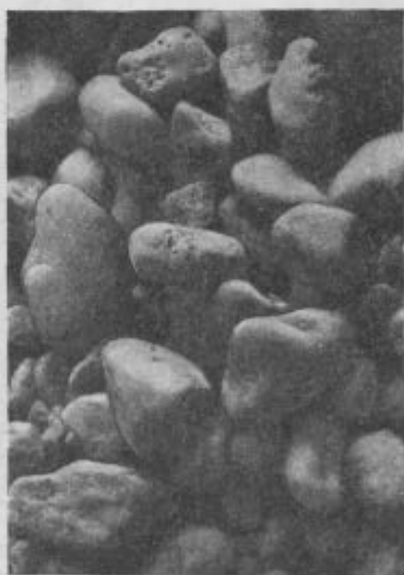
Фиг. 1. Различная степень окатанности минеральных обломков. (По Апродову, 1937). 1 — обломки остроугольные; 2 — обломки плохо окатанные; 3 — обломки среднеокатанные; 4 — обломки хорошо окатанные
