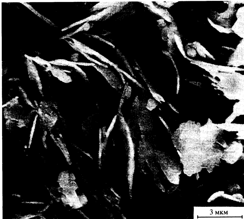
Рис. 65. Микроструктура морского осадка иллитового состава
