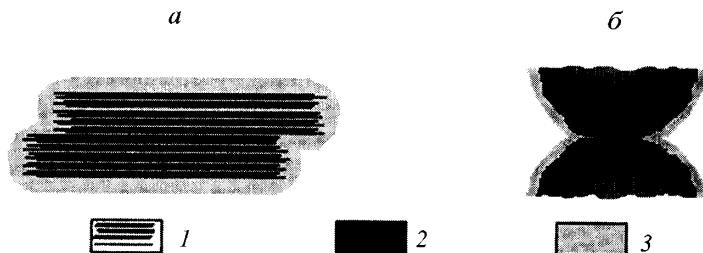
Рис. 27. Схемы фазовых кристаллизационных контактов, образующихся за счет: а – сил ионно-электростатической природы; б – сил химической природы при пластичном деформировании частиц в зоне контакта (“холодная спайка”)
