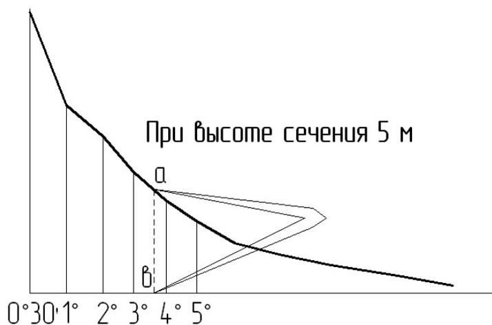
Рисунок 2.40 – График заложений для углов наклона
