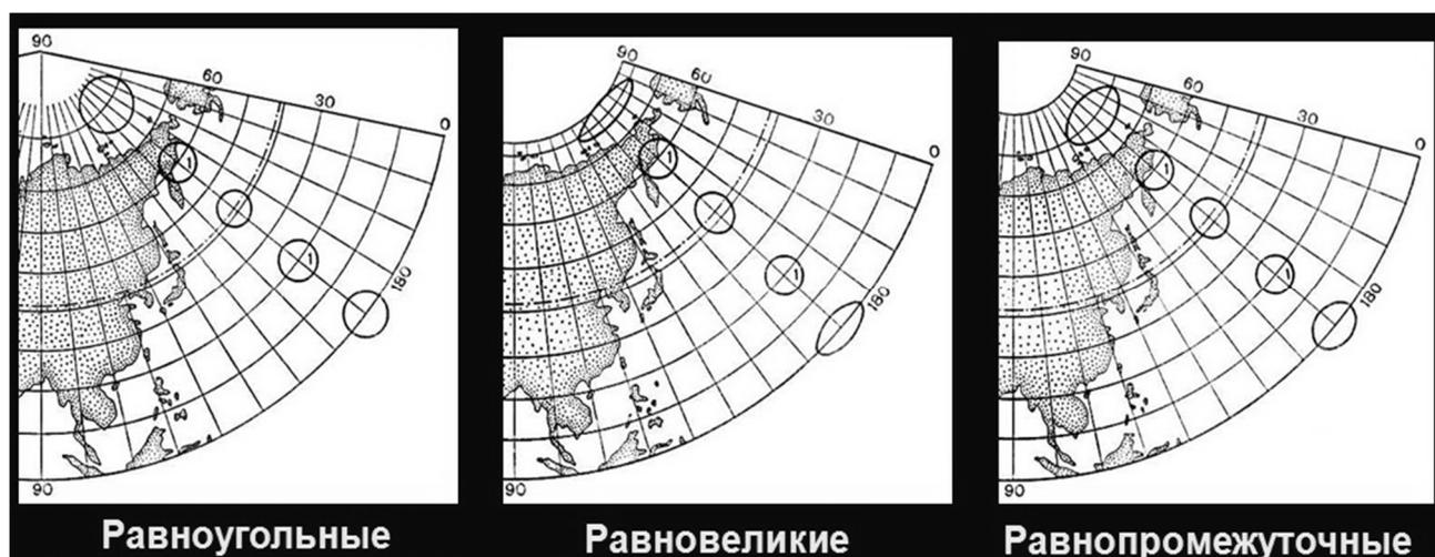
Рисунок 1.5 – Классификация проекций по характеру искажений
