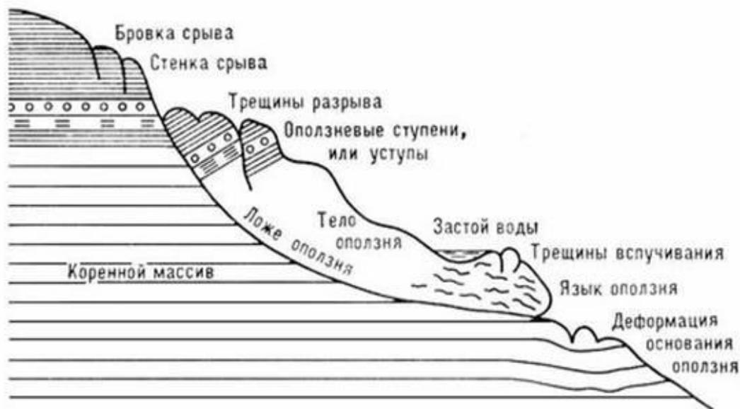
Рис. 37. Продольный разрез склона с телом оползня
