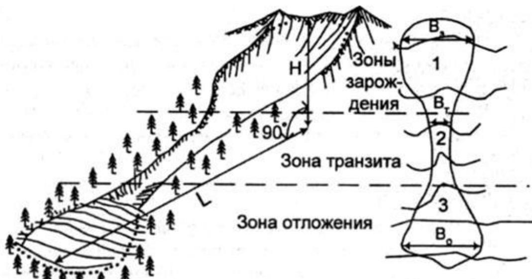
Рис. 33. Типичный лавиносбор (схема)
