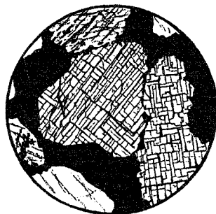
Рис. 45. Спайность диопсида в сечении, перпендикулярном оси c . Зарисовка фрагмента шлифа пироксеновых скарнов месторождения Таежное. Увел. 20 x
