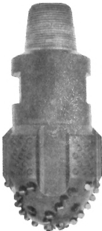
Рис. 1.3. Твёрдосплавное буровое долото
