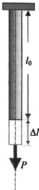
Рис. 2.1. Схема эксперимента для построения зависимости « \sigma - \epsilon »
