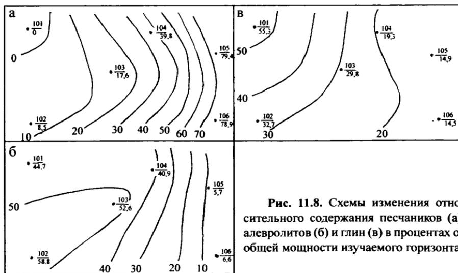
Рис. 11.8. Схемы изменения относительного содержания песчаников (а), алеволитов (б) и глин (в) в процентах от общей мощности изучаемого горизонта
