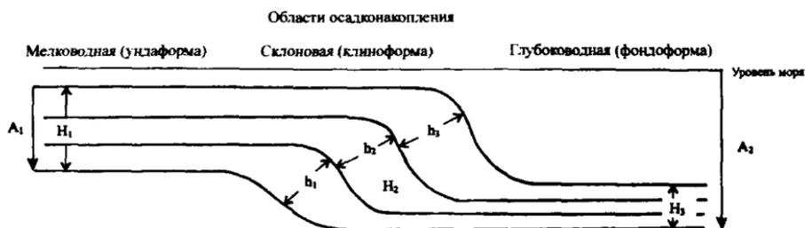
Рис. 9.1. Схема соотношения мощностей отложений и амплитуды тектонических прогибаний в различных батиметрических областях водоема
