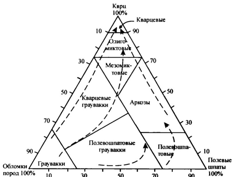
Рис. 6.6. Классификация песчано-алевритовых пород по минерально-петрографическому составу (Шванов, 1987).
