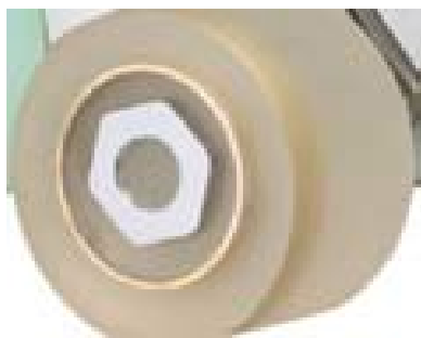
VersoCit – повседневная заливка образцов низкой и средней твердости. Время затвердевания 10–20 мин.
