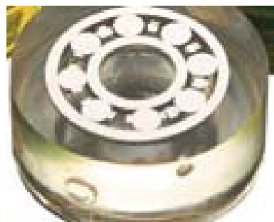
EpoFix – эпоксидная смола с очень низкой вязкостью и временем затвердевания 12 часов. Идеально подходит для вакуумной импрегнации пористых образцов. Очень высокое заполнение пор и трещин. Очень высокая адгезия.
