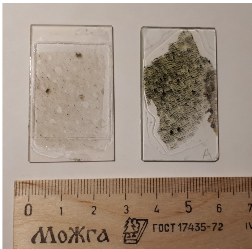
Рис. 2.18. Шлифы (слева – покрытый, справа – плоско полированный)
