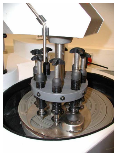
Рис. 2.13. Процесс шлифования на станке RotoPol-35/PdM-Force-20
