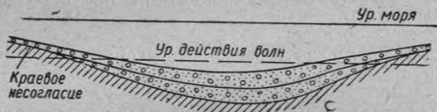
Рис. 121. Схема накопления осадков в формирующейся синклинальной складке (объяснение в тексте)
