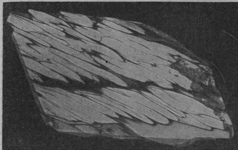
Рис. 201. Кливаж, делящий слои известняка на линзы. Керн из отложений нижнего турне Атасуйского района Центрального Казахстана
