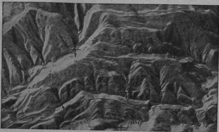
Рис. 83. Пластовые треугольники при пологом залегании пород и плавном залесенном рельефе
