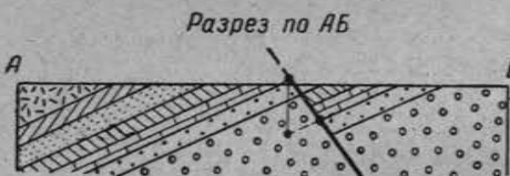
Рис. 150. Пример, иллюстрирующий определение амплитуды сброса на разрезе, построенном вкрест простирания сместителя
