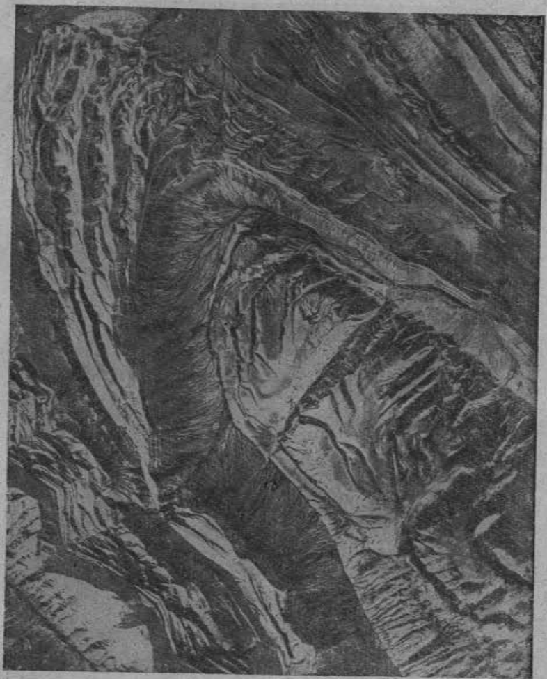
Рис. 124. Антиклинальная складка с симметричным расположением слоев на крыльях. Масштаб аэрофотоснимка 1:30 000
