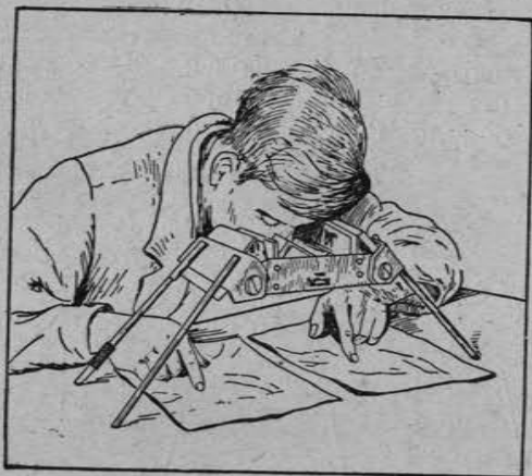
Рис. 12. Работа с зеркально-линзовым стереоскопом Т-3
