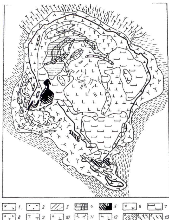
Рисунок 18 - Геологическая схема Ковдорского массива. По В.И. Терновому и др., 1977: 1-12 – породы щелочно-ультрамафитовой формации; 13 – гнейсы и гнейсограниты беломорской серии: а-княжегубская, б-чупинская, в-лоухская свиты.
