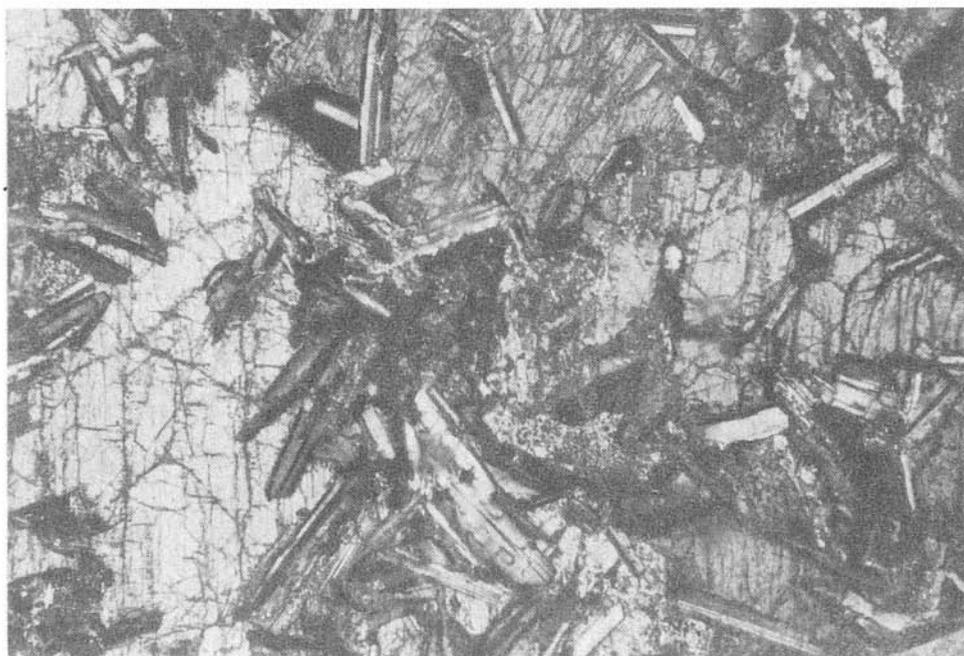
Фото 12. Габбро-долерит с пойкилоофитовой структурой. Видны ойкокрислы свежего клинопироксена, Шл. ХТ-47. Ув. 63. Ник. +.
