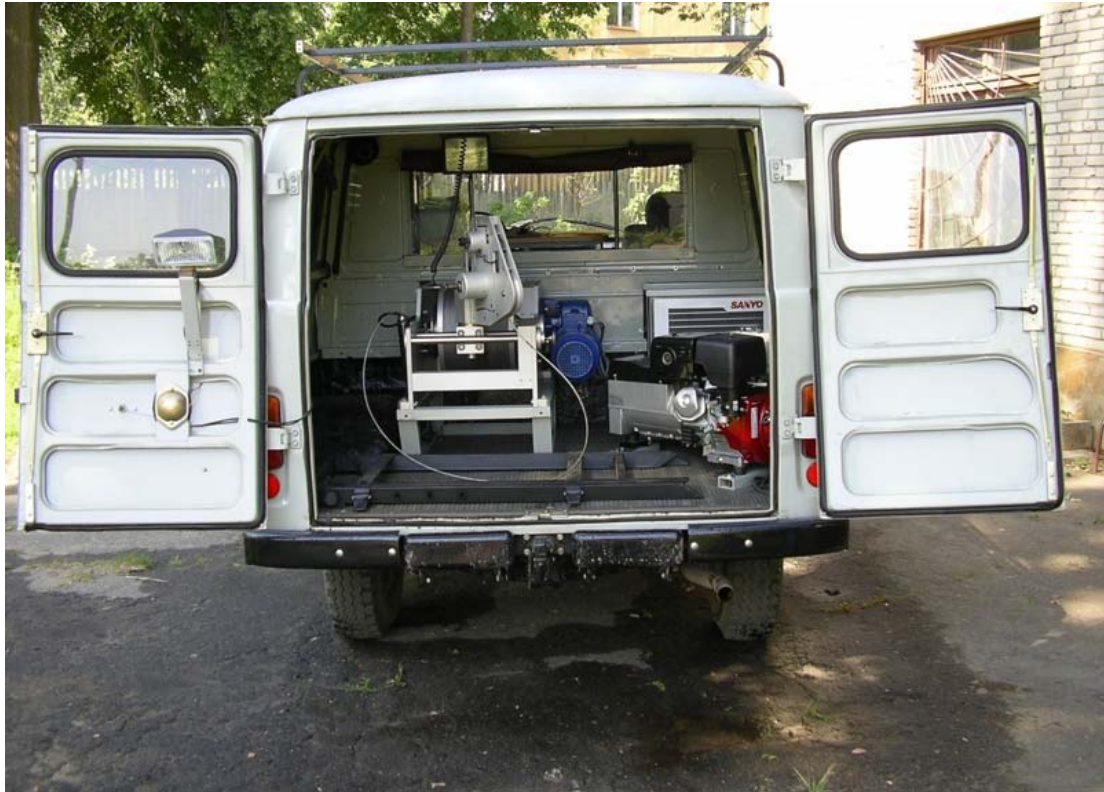
Рис. 8.4. Каротажная станция на шасси УАЗ-3909 (с электролебедкой)
