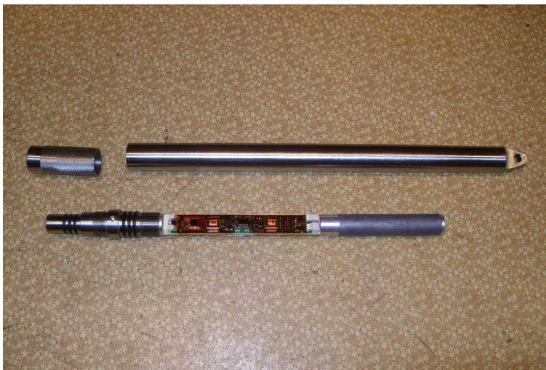
Рис. 8.8. Радиометр скважинный СПР-38МК (вид со снятым кожухом)
