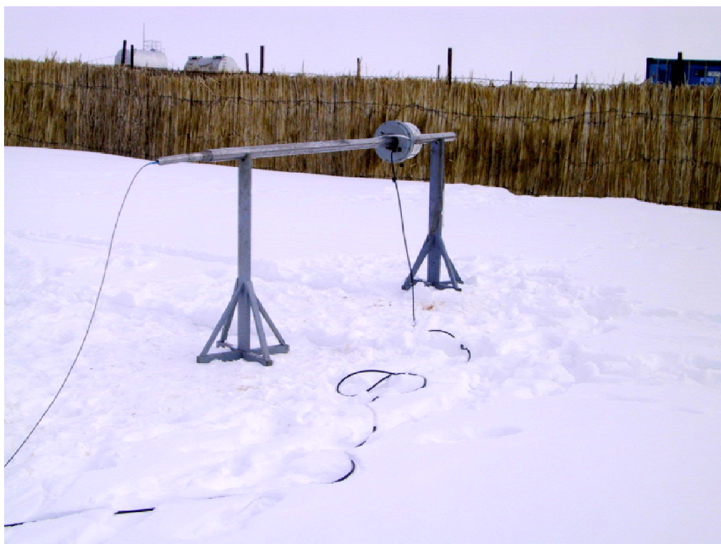
Рис. 8.13. Скважинный прибор АИНК-60 с блоком градуировки мониторов
