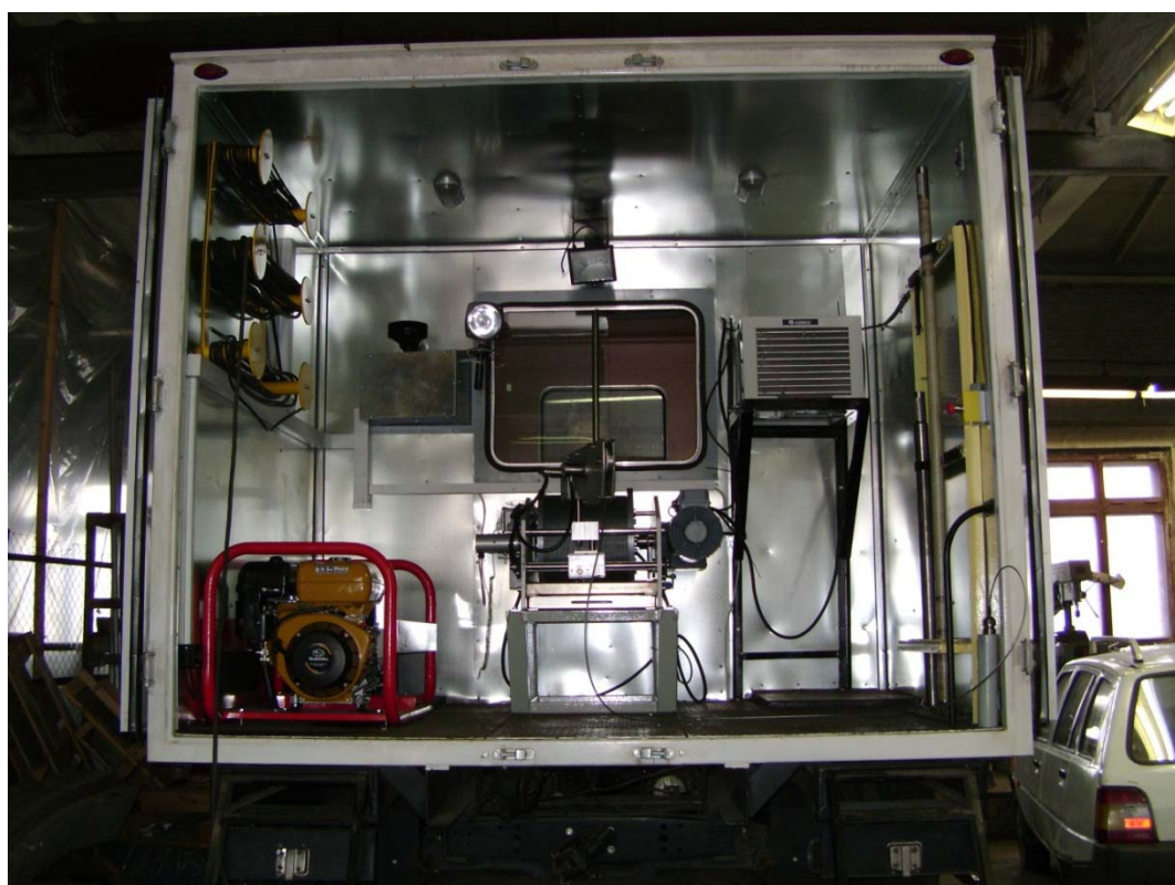
Рис. 8.3. Каротажная станция на шасси ГАЗ-33081 (с электролебедкой)
