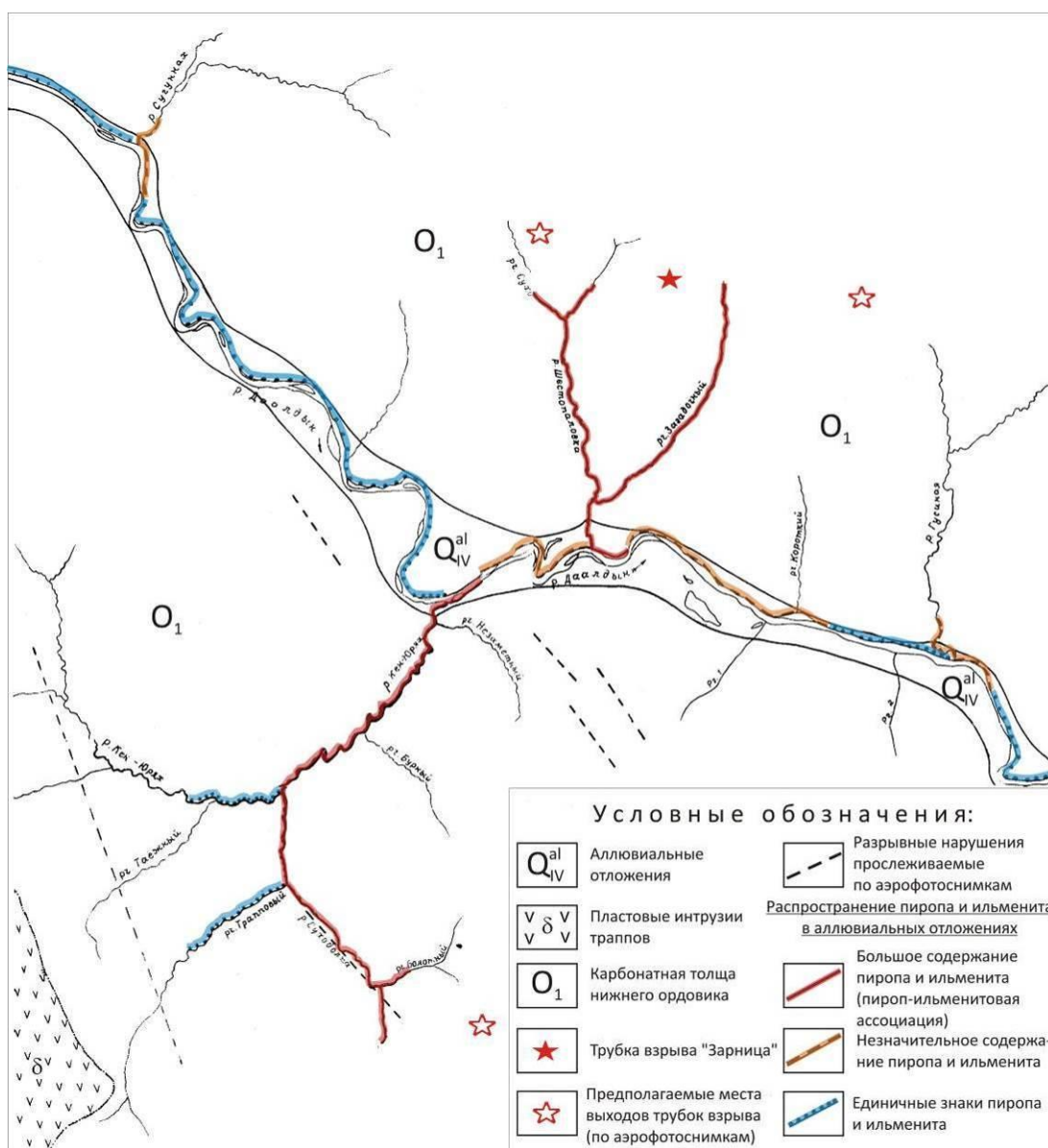
Рис. 10. Схематическая геологическая карта бассейна среднего течения р. Даалдын, составленная Л. А. Попугаевой в 1954 г. с использованием аэрофотоматериалов. Цветом показаны ранги распространения пиропса и ильменита в аллювии
