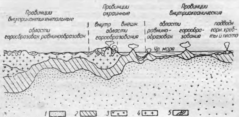
Рис. 10. Схематический разрез земной коры в разных типах геологических провинций (по В. И. Попову): 1 — перидотит (сима); 2 — базальт (силь); 3 — гранит (силь палеозойский); 4 — гранит (силь археопротерозойский); 5 — осадочные формации докола.
