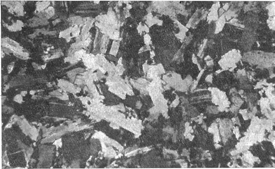
Рис. 6. Мелкозернистый альбитит с призматическизернистой основной массой. Увел. 34, с анализатором
