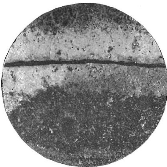
Рис. 56. Осветление порфирита в альбандах амфиболовой жилы (поперечный срез керна). Мульгинское месторождение, скв. 12, глубина 194 м. Нат. вел.
