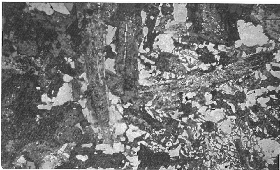
Рис. 26. Образование метасоматического микропегматита в габбро-диорите. Увел. 15, с анализатором
