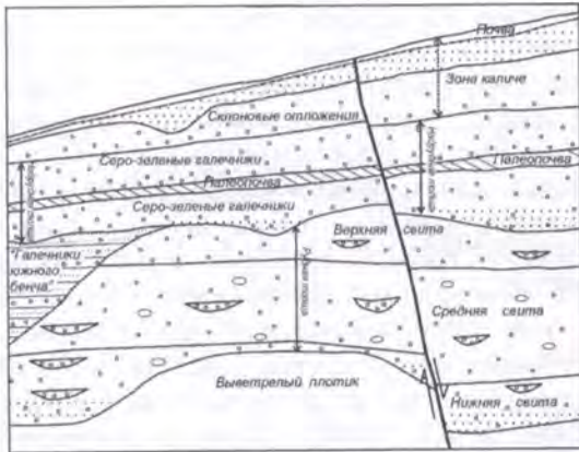
Рис. 4.49. Обобщенный разрез плиоцен-нижнечетвертичных конгломератов месторождения Нижний Олингхаус (Невада)
