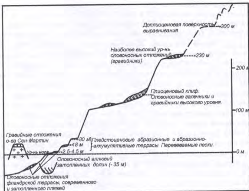
Рис. 4.32. Схема, иллюстрирующая последовательность формирования и геоморфологическую позицию оловянных россыпей Корнуолла (Yosking, Gamm, 1984)
