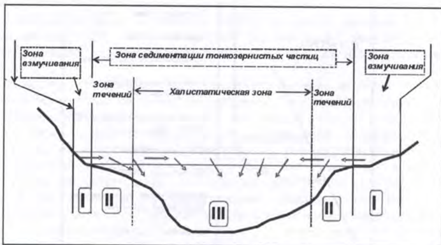
Рис. 1.16. Схема дифференциации кластогенных минералов и формирования россыпей в малых озерных ваннах (Патык-Кара, 1996)
