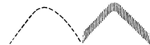
Фиг. 86. Расположение чешуек слюды в ступенчатом шарнире складки скальвания (правый рисунок) и в гладком шарнире складки изгиба (левый рисунок).
