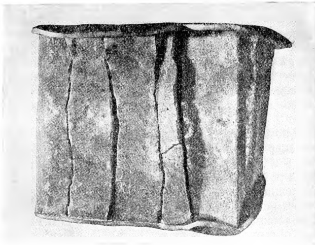
Фиг. 17б. Трещины разрыва (кубик гранита; раздавлен на свинцовой прокладке). (Фото А. И. Корсунского).
