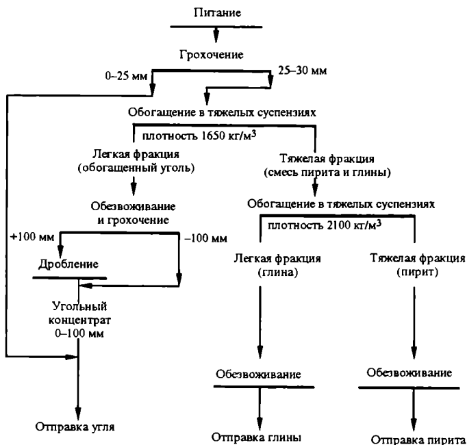
Рис. 11.13. Принципиальная технологическая схема перерабатывающей установки на фабрике разреза «Климовский»
