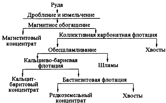
Рис. 4.15. Принципиальная схема обогащения бастнезитовых руд
