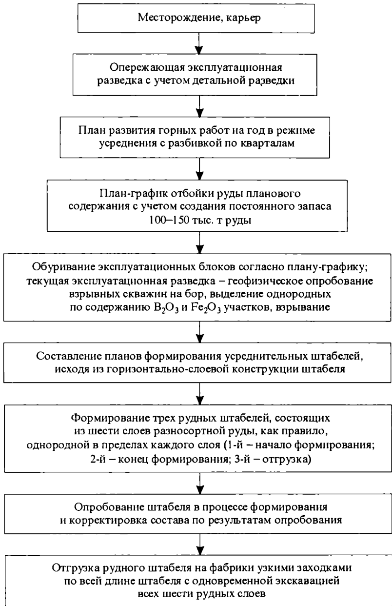
Рис. 2.2. Принципиальная схема усреднения датолитовой руды
