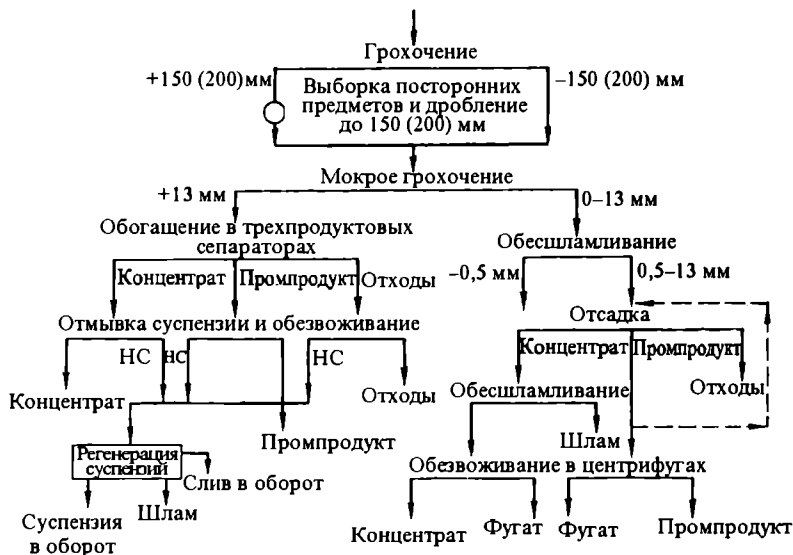
Рис. 11.4. Схема обогащения коксующихся углей средней и легкой обогатимости (НС — некондиционная суспензия)
