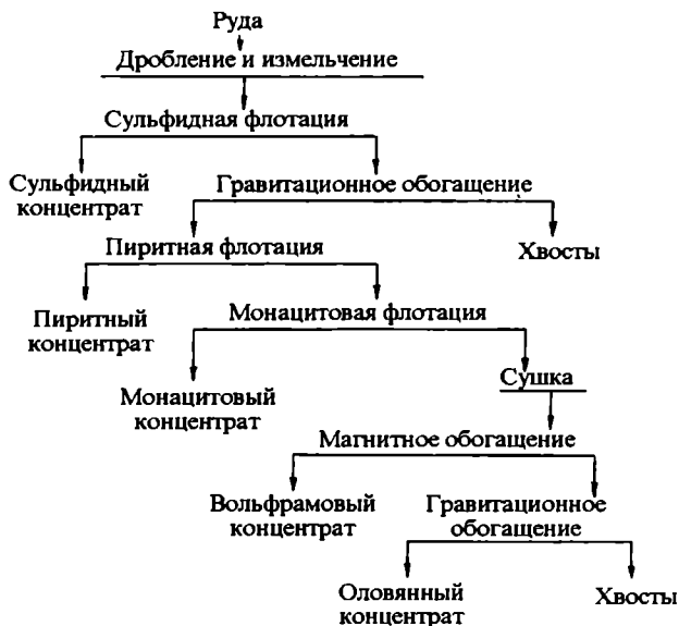
Рис. 4.14. Принципиальная схема обогащения комплексных монацитовых руд
