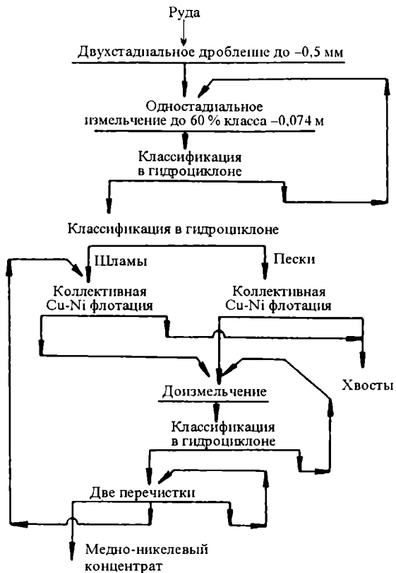
Рис. 3.5. Принципиальная технологическая схема обогащения медно-никелевых руд на фабрике «Замбейлз»
