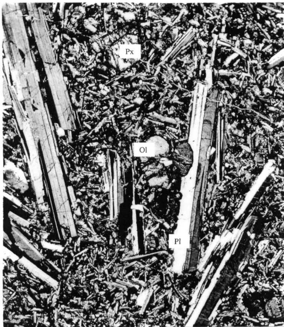
Рис. 4.2. Pl-,Ol, Px-порфировый базальт. Обр. 95-56, скв. Хохряковская-58, глубина отбора 2797,2 м, увеличение 30х, николи +, (Pl – плагиоклаз, Ol – оливин, Px – пироксен).
