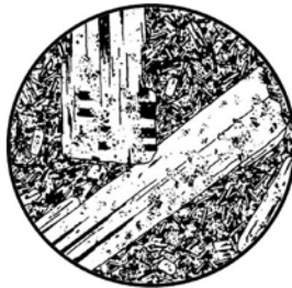
Рис. 11.3. Структура порфировая с микролитовой андезитовой структурой основной массы. В порфировых выделениях крупные удлиненные зерна плагиоклаза
