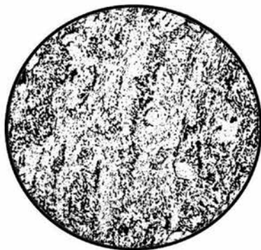
Рис. 17.1. Милонитизированный мигматит. Структура милонитовая. Параллельно ориентированные чешуйки слюды тонко перекрыты под влиянием давления.
