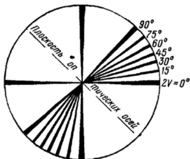
Рис. 6.5. Диаграмма для приближенной оценки величины угла оптических осей в разрезе, перпендикулярном к оптической оси
