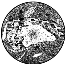
Рис. 11.4. Структура порфировая, скрытокристаллическая с фельзитовой структурой основной массы. Фенокристаллы представлены ортоклазом, основная масса – смесью кварца и полевых шпатов
