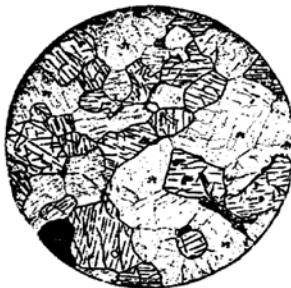
Рис. 10.5. Структура габбровая. Без анализатора. Одинаковая степень идиоморфизма (гипидиоморфные) пироксенов (светлые с жирными линиями спайности) и плагиоклазов (легкий крап с тонкими линиями спайности). Форма кристаллов изометричная.
