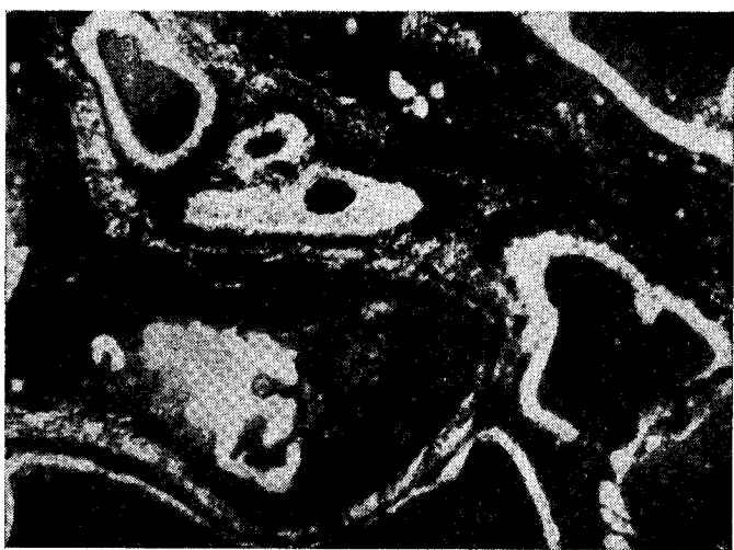
Рис. 62. Микроструктура брикета окиси хрома с алюминием после нагрева до 1300^{\circ}\text{C} . Светлые полосы — пути миграции алюминия. \times 115
