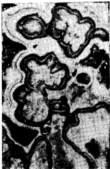
Рис. 102. Микроструктура настыли, состоящей из слоев \text{SiO}_2+\text{SiC} (светлые) и \text{SiO}_2+\text{Si} (темные). Снято в темном поле. \times 70
