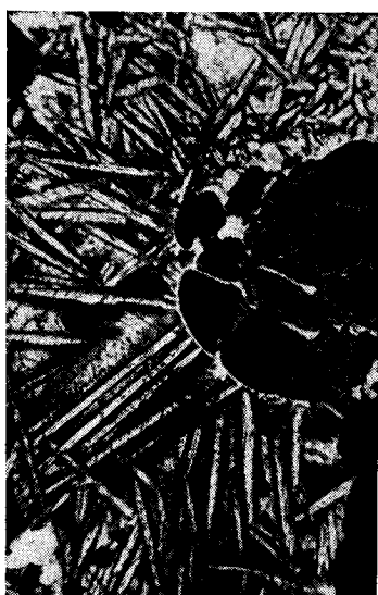
Рис. 36. Микроструктура продукта восстановления руды В при 1350^\circ\text{C} в течение 4 ч. Основная масса — стекло и форстерит (тонкие призмы). Темные включения — резорбированные зерна хромшпинелида. Свет проходящий. \times 40
