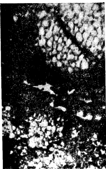
Рис. 95. Микроструктура хромомагнезитового кирпича, примыкающего к настели. Агрегаты зерен периклаза (светлые) с периферии насыщены магнезиоферритом (темное). Свет проходящий. \times 36
