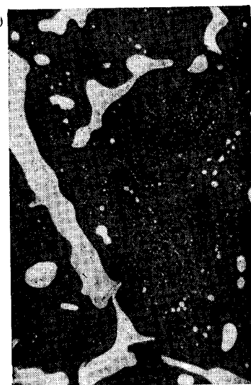
Рис. 44. Микроструктура частично восстановленной хромовой руды. Белое — металл в хромшпинелиде. \times 115
