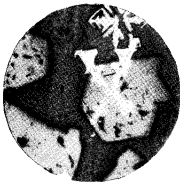
Рис. 78. Скелетные кристаллы хрома (белые) в шлаке от выплавки хрома печным алюминотермическим способом. Крупные включения — хромовая шпинель; основа — майенит и \alpha - 12\text{CaO} \cdot 7\text{Al}_2\text{O}_3 . \times 120
