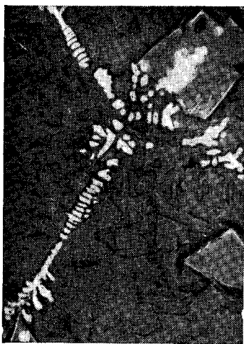
Рис. 80. Скелетные кристаллы хрома (белые) в шлаке печной алюминотермической выплавки хрома. Крупные серые кристаллы — хромовая шпинель. Основа — майенит и фаза \alpha '- 12\text{CaO} \cdot 7\text{Al}_2\text{O}_3 . \times 250
