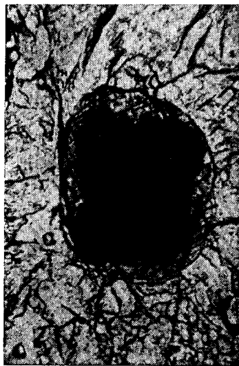
Рис. 38. Реликтовое зерно хромшпинелида (черное), с периферии замещенное периклазом, среди стекловидной шлаковой фазы. Руда В, 1600°C, 4 ч. Свет проходящий. \times 40
