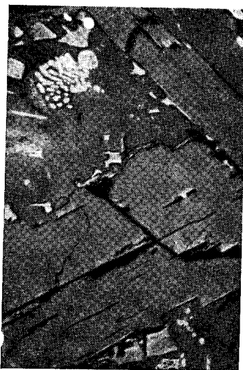
Рис. 77. Микроструктура шлака промышленной плавки хрома электропечным алюмотермическим способом. Призмы — известковый \beta -глинозем; цементирующая масса — двуалюминат кальция; изометричные кристаллы в нем — хромовая шпинель; белое — металл. \times 200
