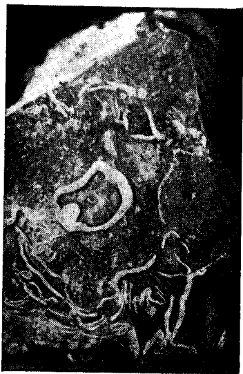
Рис. 25. Внешний вид образца бокового гарниссажа. Светлые полосы—конденсаты; серые включения—частицы карбидизированного кокса; основная масса—спекшийся, кристобалитизированный кварцит. Натуральная величина
