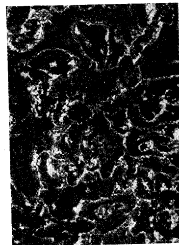
Рис. 58. Брикет после нагрева до 1100^\circ\text{C} и выдержки 10 мин. На месте частиц алюминия — полости (черное). \times 25
