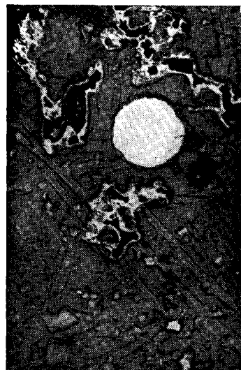
Рис. 47. Микроструктура шлака промышленной плавки ферросиликохрома. Белый корольек — металл; белые ажурные включения псевдоморфозы \beta-SiC по коксу; изометричные серые зерна — шпинель; призмы — форстерит. \times 115
