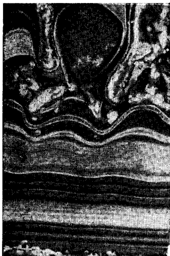
Рис. 105. Слоистое строение настыли со сводовой плиты. Снято в темном поле. \times 70
