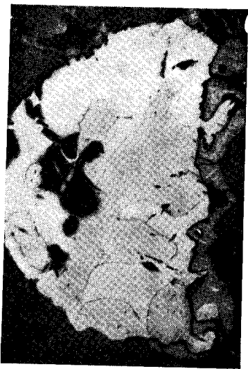
Рис. 30. Гранула ферросилиция, состоящая из моносилицида железа (серое) и дусилицида (светло-серое), частично замещенная карбидом кремния (темно-серая оторочка внизу). X112
