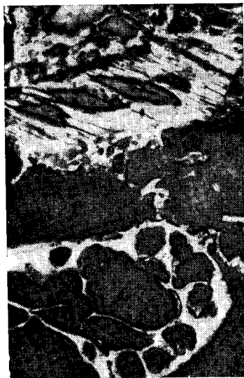
Рис. 26. Микроструктура бокового гарниссажа. Агрегаты дисперсного \beta\text{-SiC} (светлые), образовавшегося по коксу (серые реликтовые включения) среди силикатного стекла. \times 70
