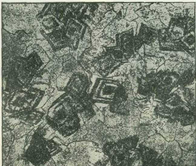
Фиг. 2. Микроскопические ромбы доломита с зонарным строением. Увел. 70. (По Л. Кайэ, 1935).
