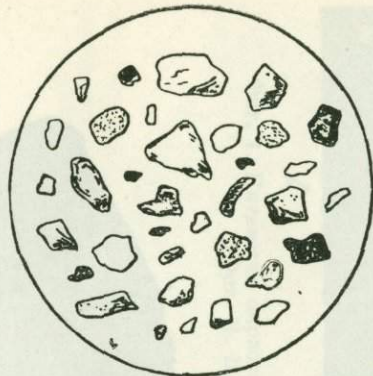
Фиг. 2. Китайский лёсс под микроскопом. Увел. ок. 25. (По Мэриалу, из Г.Мильнера, 1929).
