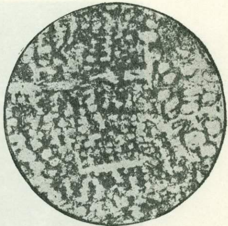
Фиг. 3. Полированный шлиф псевдо- морфозы хальковина по древесине. Увел. 320. (По И. С. Яговкину, 1932).
