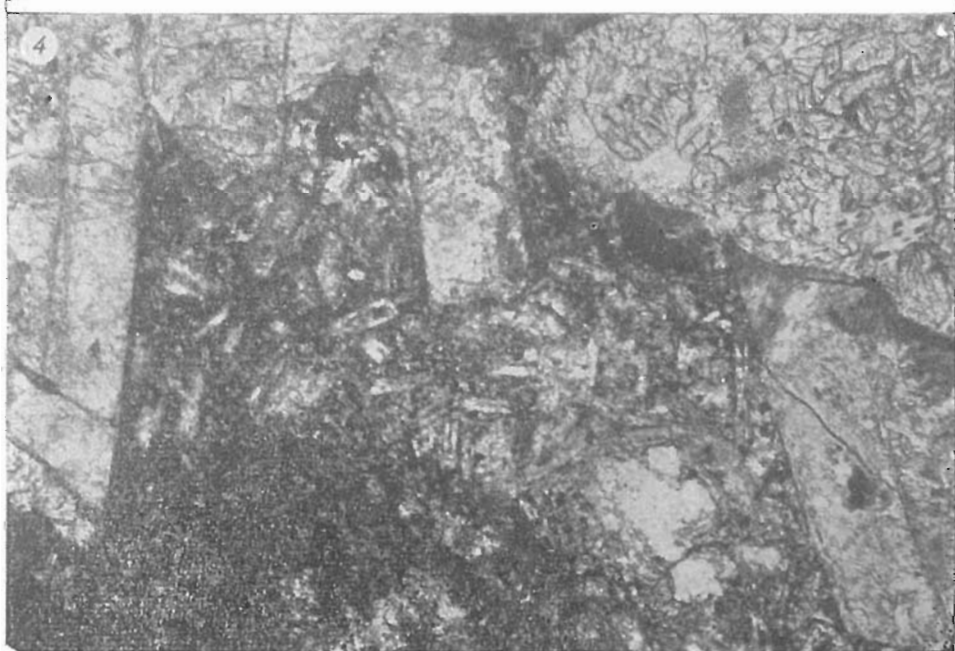
3. Псевдоташилит. Общий вид под микроскопом. Шл. 1/583,5, ув. 40, без ник. 4. Переход от ороговикованного габбро-долерита к псевдоташилиту, замещаемому существенно клиношироксеновым метасоматитом. Шл. 4/516, ув. 40, без ник.
