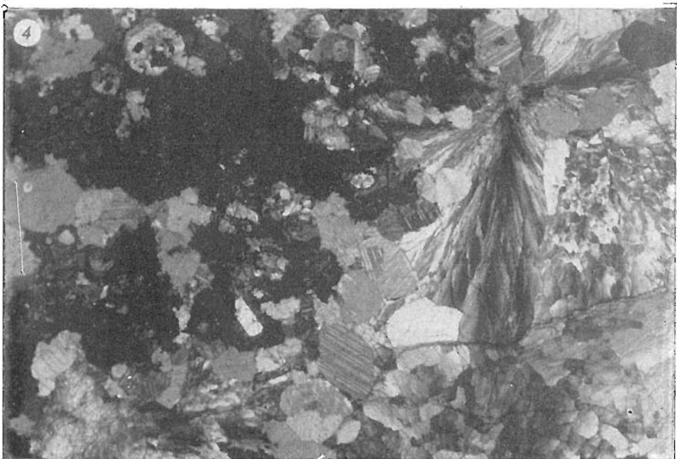
3. Губчатый каркас с сотовой структурой, образованный гранатом и рудными минералами в оруденелом гранатите. Шл. 382,5/411, ув. 40, без ник.
