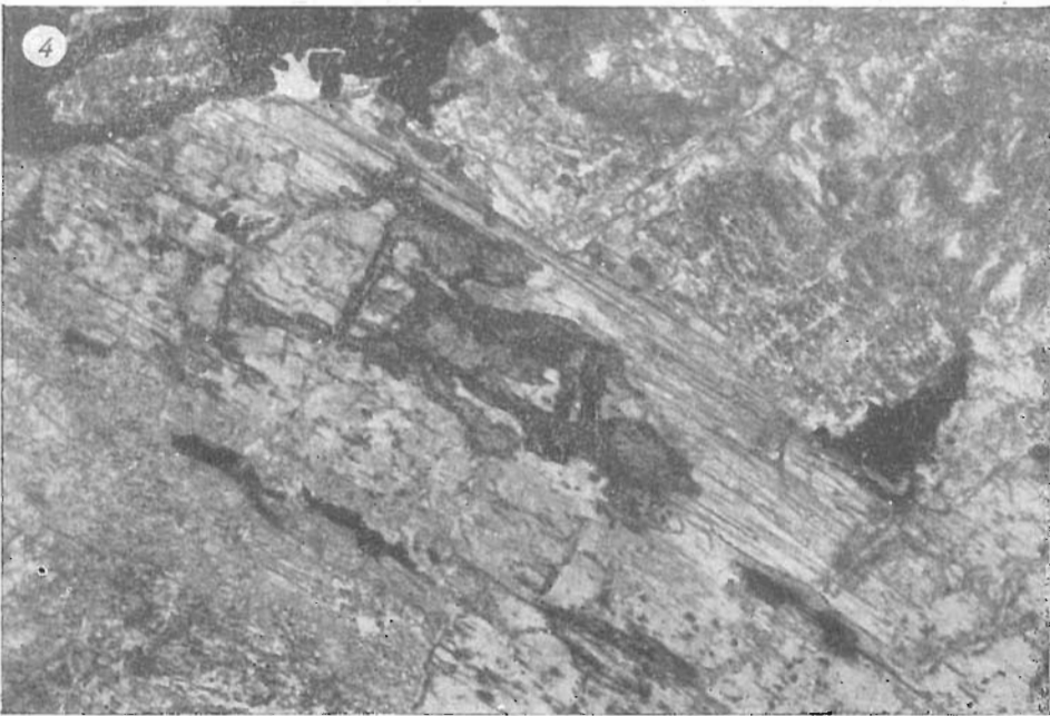
3. Структура замещения клинопироксена сульфидами с появлением мелкой сульфидной вкрапленности внутри замещаемого зерна. Шл. 670/26, ув. 50, без ник. 4. Зерна граната, располагающиеся вдоль спайности в зеленой роговой обманке в оливковых такситовых габбро-долеритах. Шл. 446/411, ув. 95, без ник.
