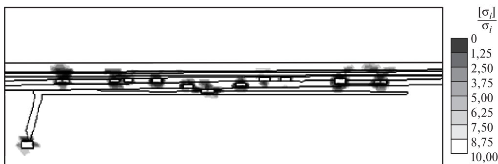
Рис. 8.14. Распределение коэффициента запаса прочности по критерию Мизеса — Шлейхера — Боткина по разрезу 2.
