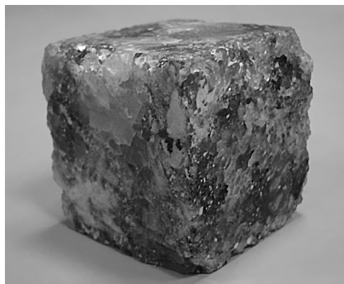
Рис. 1.9. Образец перистой каменной соли, h/a = 1 .
