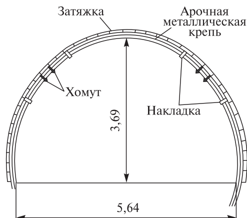
Рис. 5.4. Выработка, закрепленная металлической арочной крепью из профиля СВП 33 (шаг установки рам 1 м).
