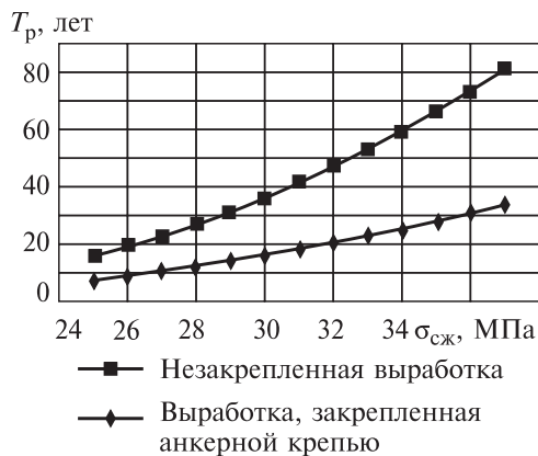
Рис. 9.2. Зависимость времени устойчивого состояния незакрепленной и закрепленной камеры питателя от средней прочности пород, слагающих ее кровлю.
