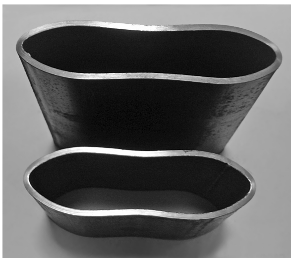
Рис. 4.11. Сегменты труб разной длины после испытания.
