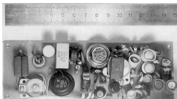
Рисунок 88 – Передатчик аппаратуры АПИК-2 и АПИК-2Р: а) общий вид; б) печатная плата с рамочной антенной; в) печатная плата первой модификации передатчика
