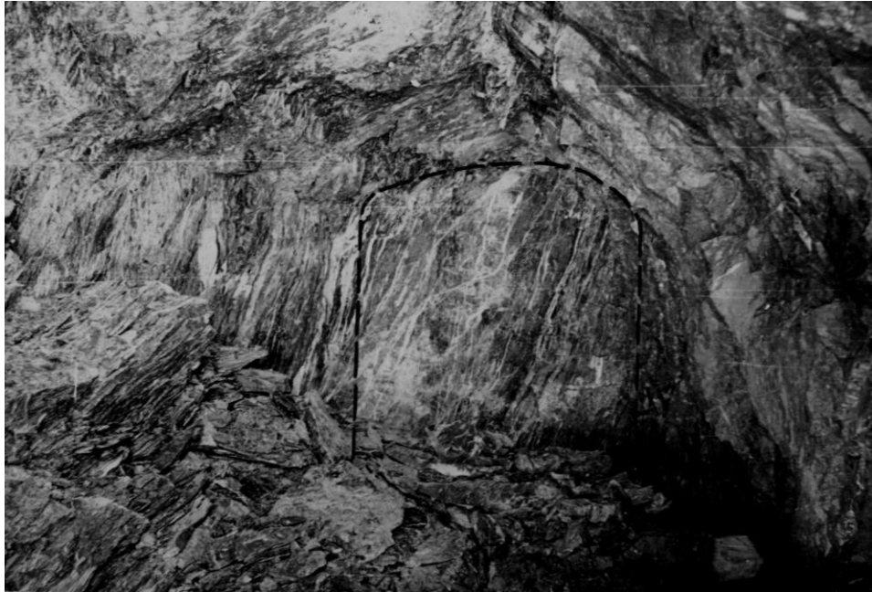
Рис. 16.11. Выброс породы в орте подсечки блока 18.
