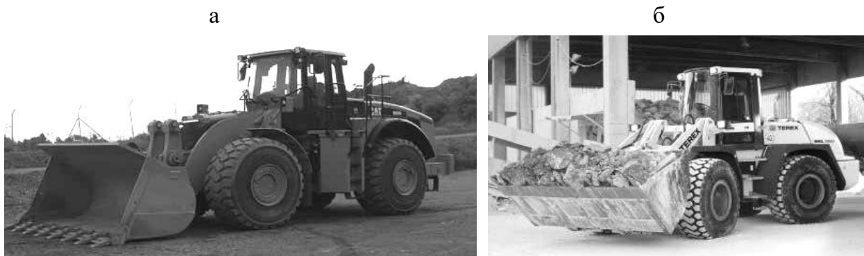
Рис. 5.7. Ковшовые погрузчики. а – «Катерпиллер»; б – Терекс.
