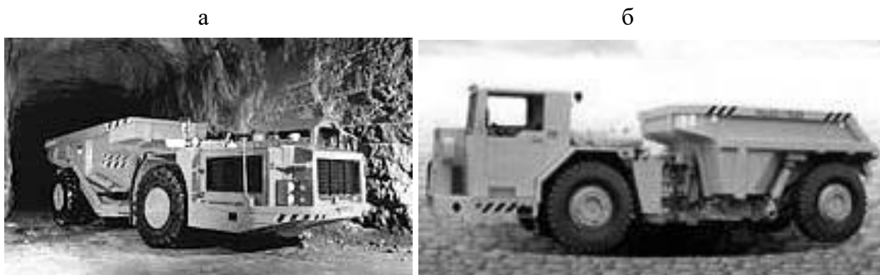
Рис. 5.10. Подземные автосамосвалы. а – Торо-40 (Финляндия); б – МоА3-7529 (Белоруссия).
