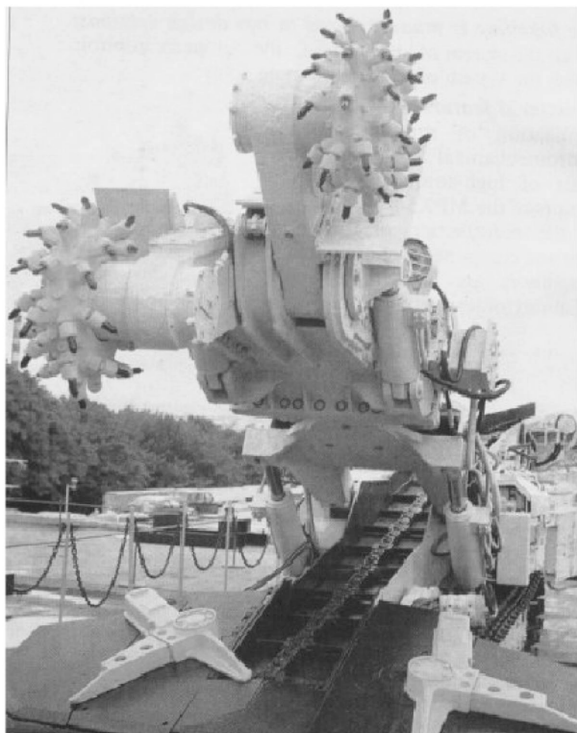
Рис. 6.1.4. Проходческий комбайн КП-20Б
