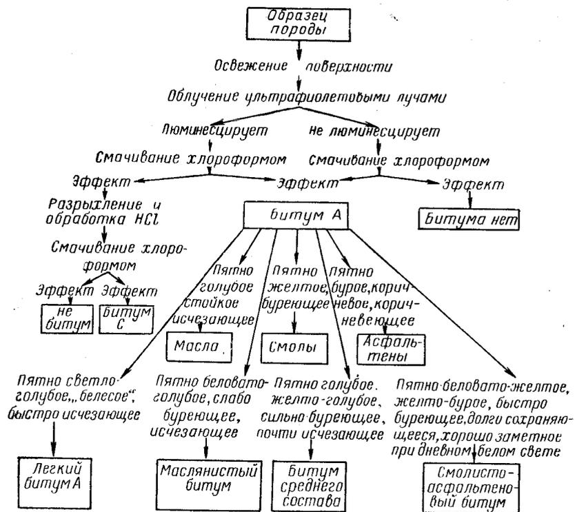
Рис. 63. Схематический ход качественного определения битума.
