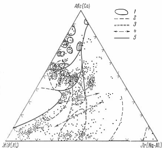
Рис. 43. Составы клинопироксенов из эклогитов и глаукофановых сланцев Калифорнии по данным исследований на электронном микроанализаторе (Essene, Fyfe, 1967)
