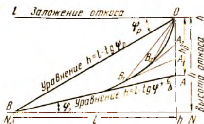
Рис. 8-21. Схема к расчету устойчивого откоса в однородной толще по методу М. Н. Тронцкой
