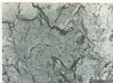
Рис. 5.33. Полнокристаллическая структура яшмы (порода сложена кварцем). Из coll. В. Н. Кондитерова.
