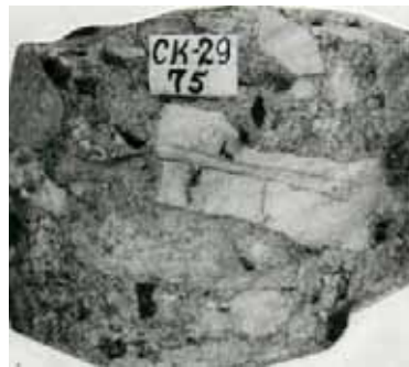
Брекчия мелкообломочная с отдельными крупными обломками, с песчано-гравийным заполняющим веществом
