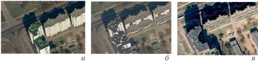
Рис. 6.21. а — стереовекторизация высотных объектов; б — внесение поправок в положение высотных объектов на ортофотоизображении; в — определение зон невидимости (геометрической тени) и их заполнение фотоизображением, например, с соседних снимков
