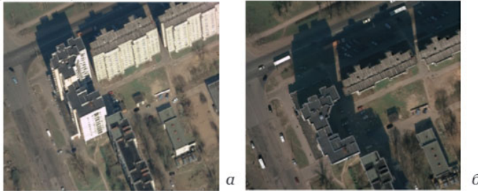
Рис. 6.22. Создание истинных ортофотопланов ( True Ortho ):
