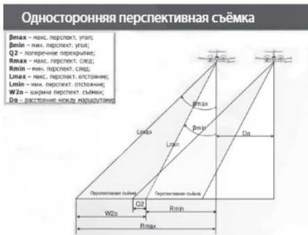
Рис. 2.15. Схема боковой перспективной съемки аэрокамерой АЗ EDGE
