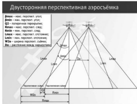
Рис. 2.14. Схема панорамирования при съемке аэрокамерой АЗ EDGE
