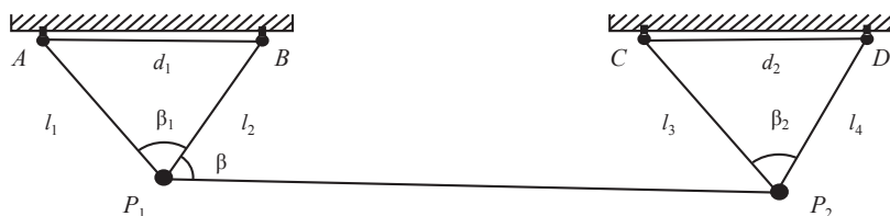
Рис. 4.11. Схемы привязки полигонометрических ходов к двойным стенным знакам
