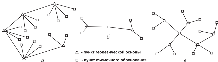
Рис. 5.2. Схемы построения съёмочного обоснования лучевым методом
