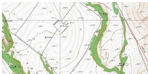
Рис. 5.13. Топографический план масштаба 1:2000
