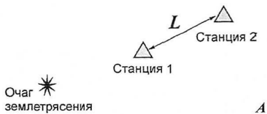
Рисунок 17 – А) Схематическое взаимное расположение регистрирующих станций и очага землетрясения в целях выявления приливных вариаций энергетического класса K .
