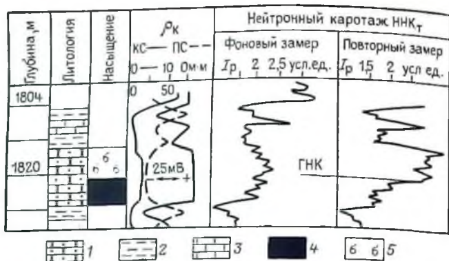
Рис. 49. Определение положения газонефтяного контакта в пласте по сопоставлению замеров нейтронного каротажа, выполненных в момент бурения скважины и в период ее эксплуатации.
