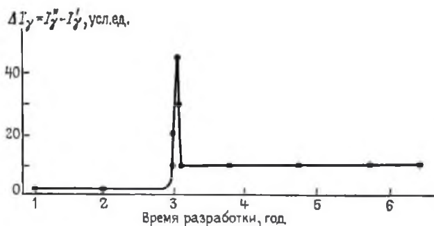
Рис. 62. Динамика естественной радиоактивности нефтяного пласта в процессе вытеснения из него нефти водой
