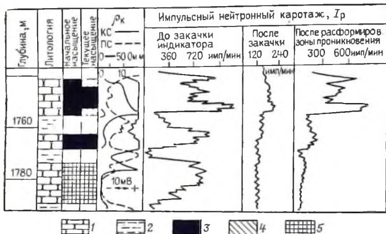
Рис. 50. Выделение продуктивных и заводненных интервалов пласта по скорости расформирования зоны проникновения промывочной жидкости, меченой нейтроннопоглощающим веществом.
