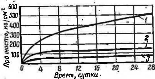
Рис. 3. Изменение прочности пластобетона на основе мономера ФА:
