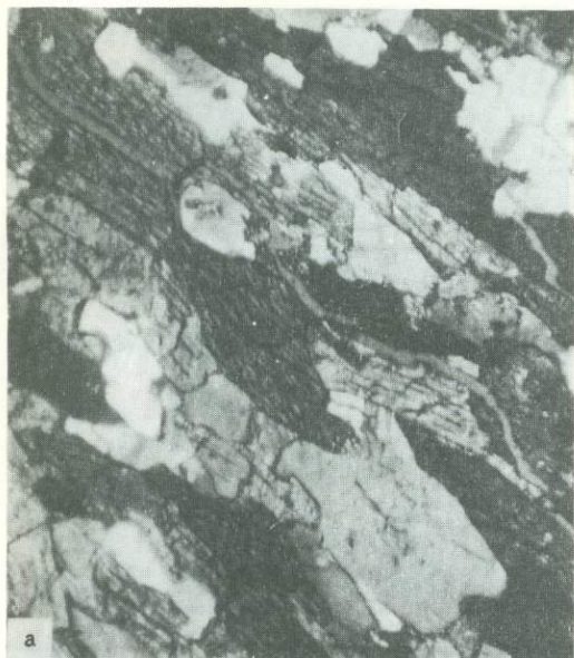
Фиг. 3. Неизменный (а) и гидротермально измененный (б) биотит-амфиболовый гнейс. Шлиф, при одном никеле. Увел. 20
