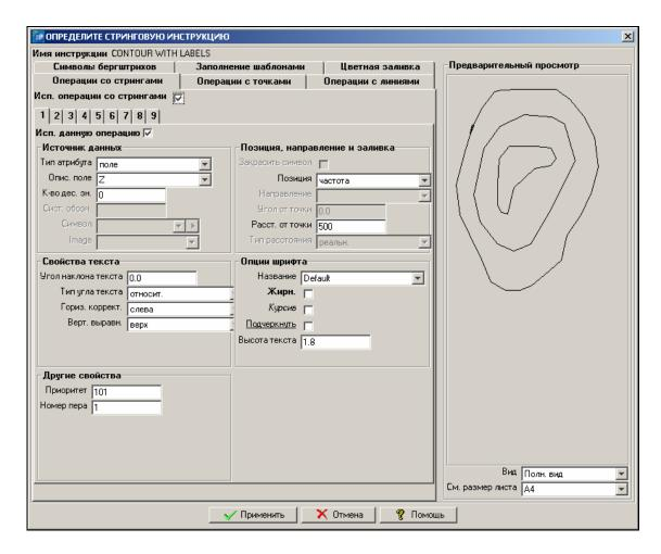
Убедитесь, что поле *Тип угла текста* установлено на *«относительный»*. При такой установке надписи значений горизонталей будут вычерчиваться параллельно горизонталям. В дополнение к функциям **Операции со стрингами** нербходимо ввести инструкции для **Операций с линиями**, указав на использование сплошной линии ( как в Инструкции для бровки).
