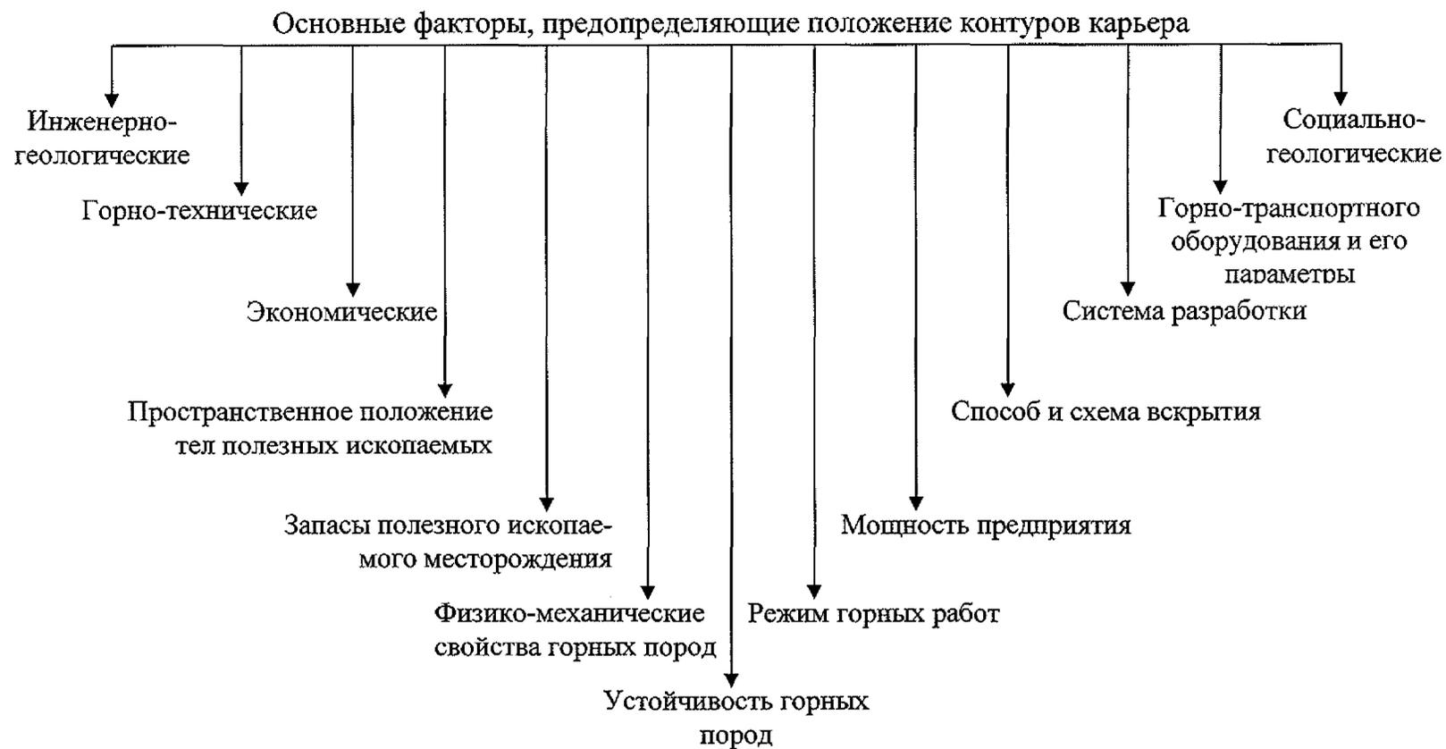
*Рис. 3.8.* Основные факторы, учитываемые при определении контуров карьера
