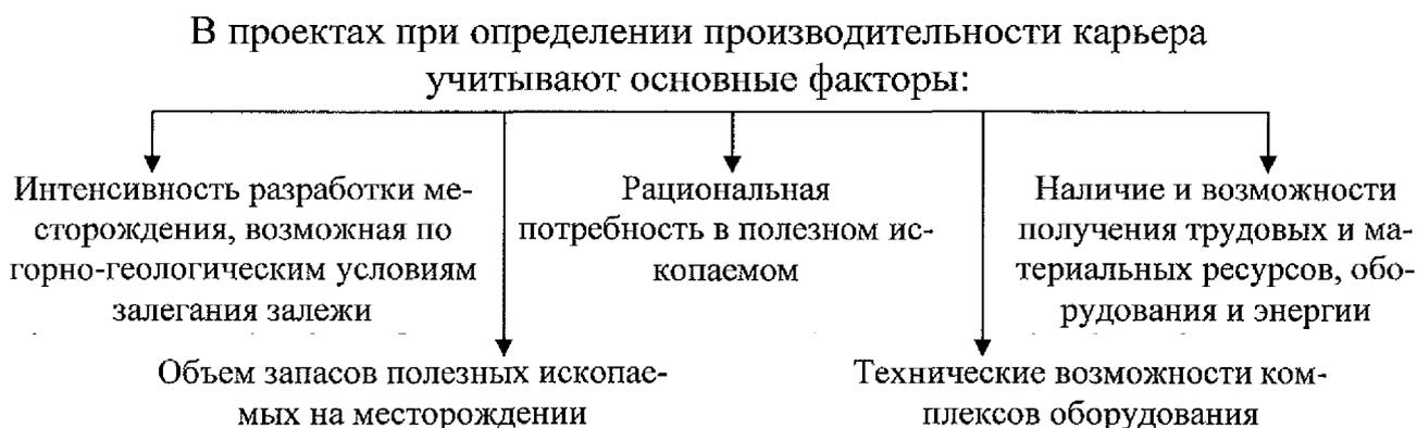
Рис. 3.2. Типы основных факторов, учитываемых при установлении проектной производительности карьера
