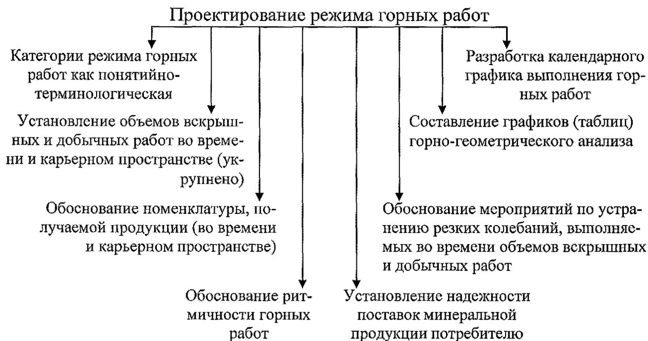
Рис. 4.10. Общий состав проектирования режима открытых горных работ
