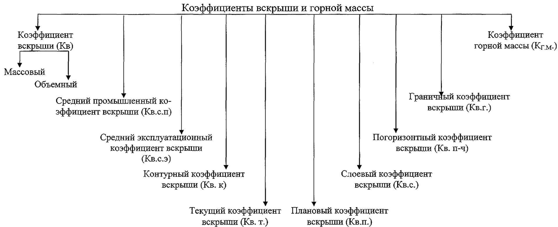
Рис. 3.6. Система коэффициентов вскрыши и горной массы
