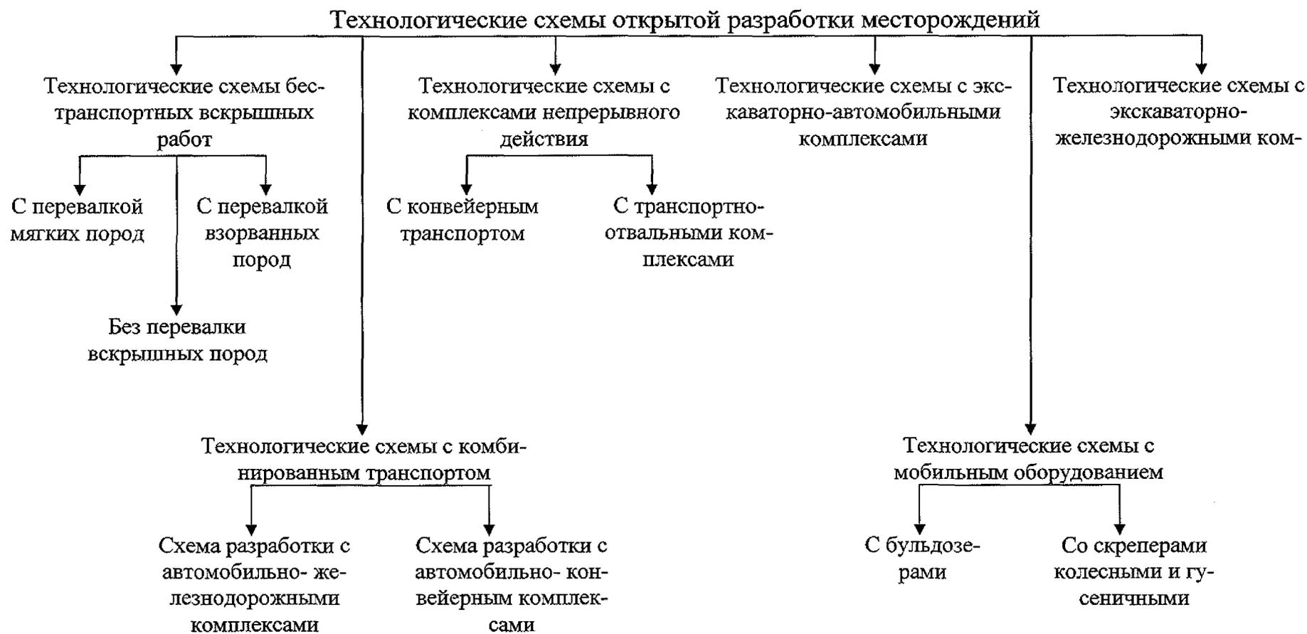
*Рис. 5.9.* Системный комплекс типов технологических схем, применяемых при открытой разработке месторождений в аспекте транспортных особенностей
