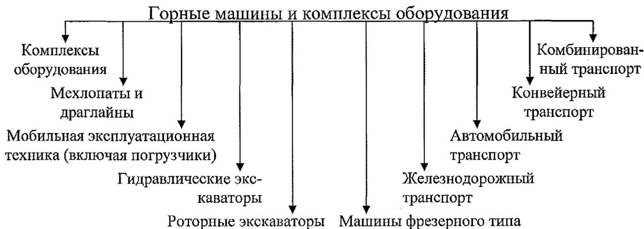
Рис. 6.3. Применяемые типы горных машин и оборудования
