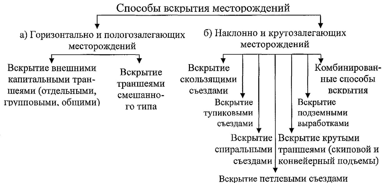
Рис. 4.3. Способы вскрытия месторождений горизонтального, полого, наклонного и крутого залегания
