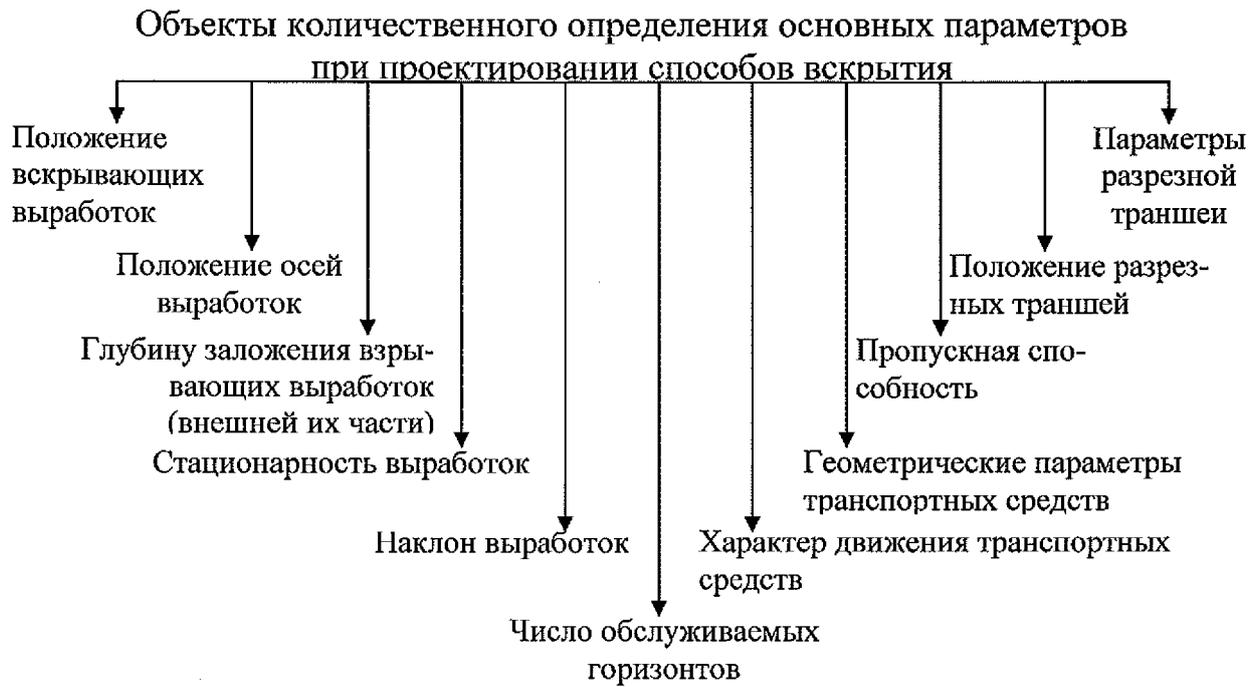
Рис. 4.4. Состав качественно определяемых параметров вскрытия месторождений
