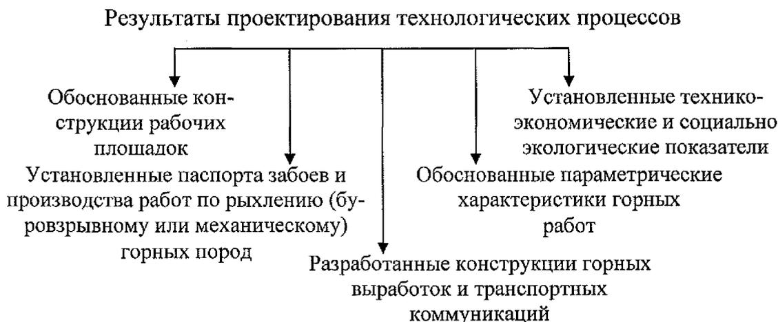
Рис. 6.2. Системный комплекс результатов проектирования технологических процессов карьеров и разрезов
