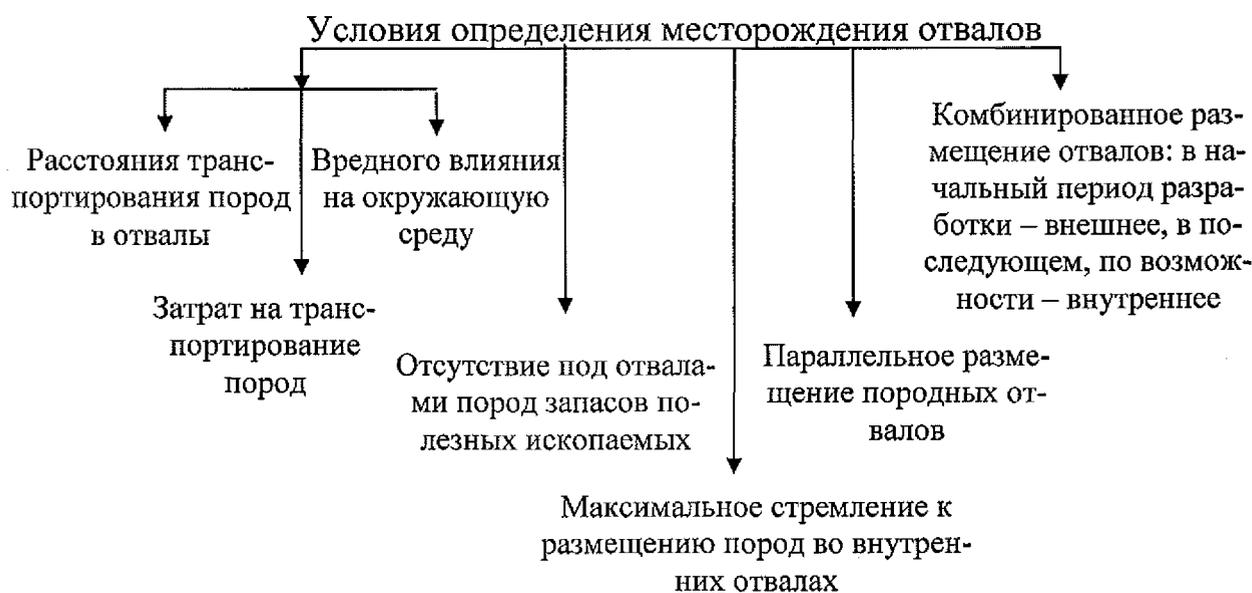
Рис. 6.8. Условия, предопределяющие рациональное местоположение отвалов
