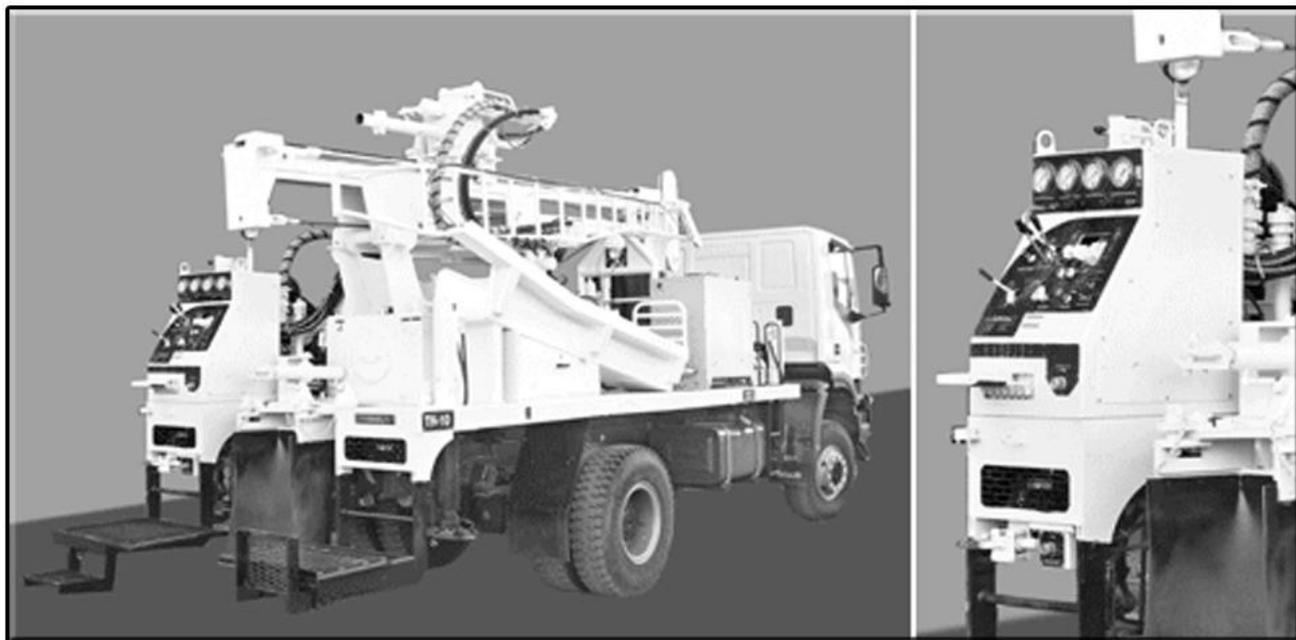
Рисунок 14. Буровая установка TH10
