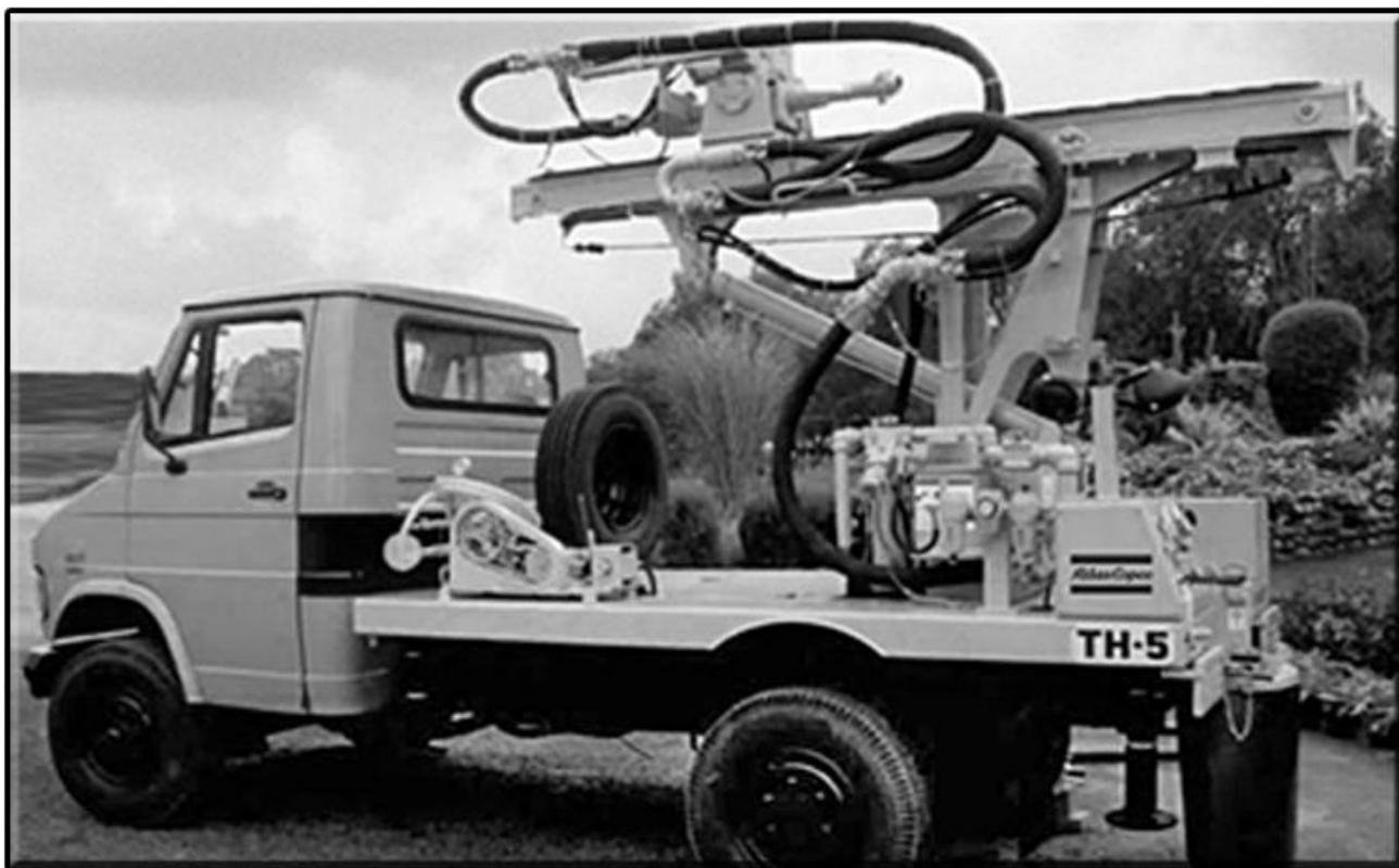
Рисунок 13. Буровая установка TH5
