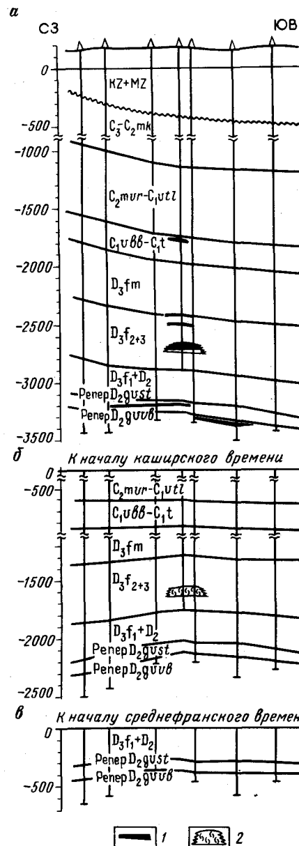
Рис. 43. Геологический (а) и палеогеологические (б, в) разрезы Ключевского шельфового биогерма. 1 — залежи углеводородов; 2 — биогермные известняки
